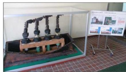
柏崎刈羽3号炉 所内変圧器の火災
