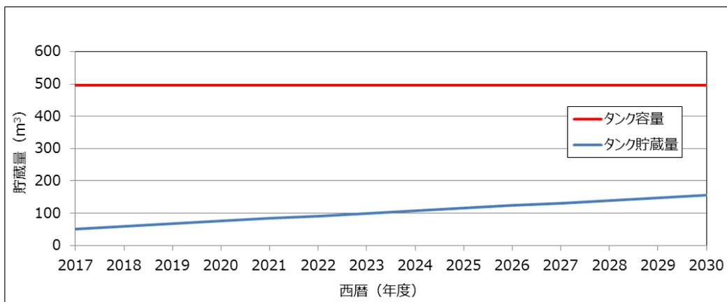
第 5-1 図 原子炉浄化系樹脂貯蔵タンクの貯蔵量推移予測
