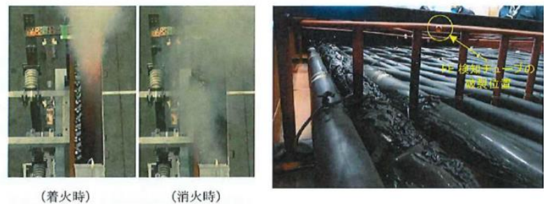
第 11 図：試験 V2 における発火・消火時の状態
