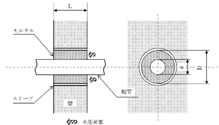
図2-16 モルタル評価概要図
