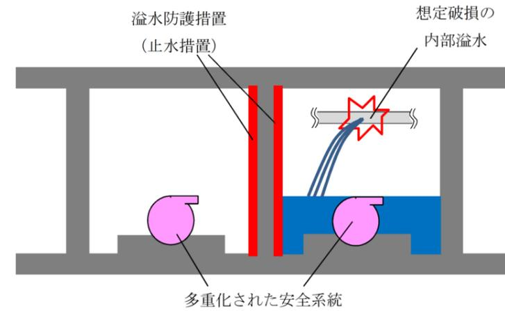
図 1-1 想定破損に対する溢水防護概念図
