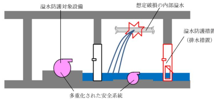
図 1-2 排水措置の溢水防護概念図
