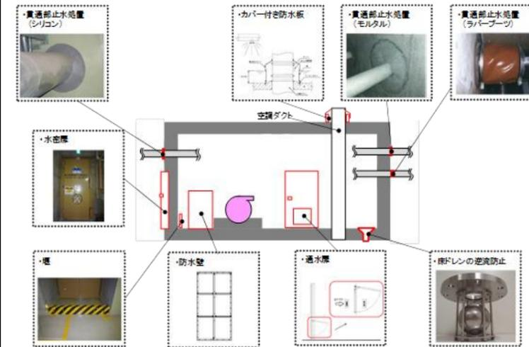
図2-1 主要な溢水防護対策の施工例
