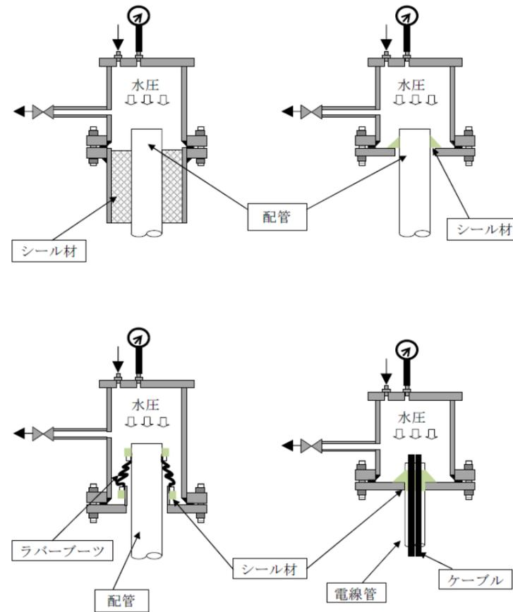
第8図 性能試験装置概要
