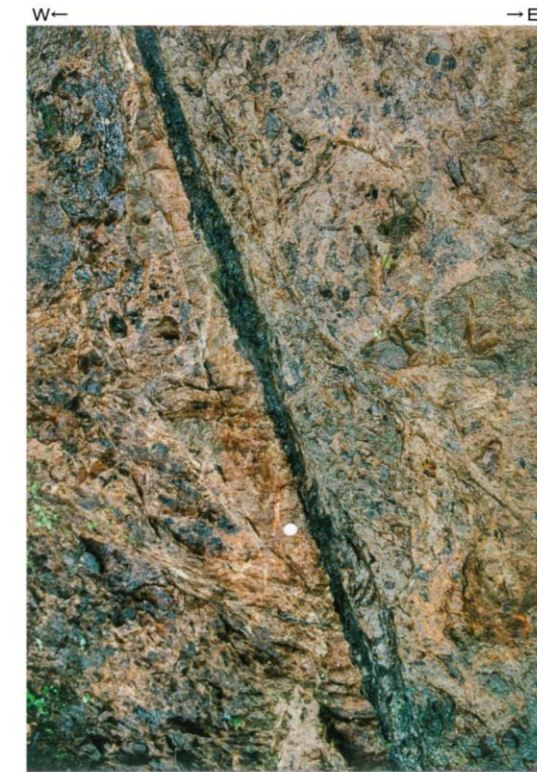
同左拡大 断層面沿いには幅2~3cmのセピオライトを伴うが、固結している。
