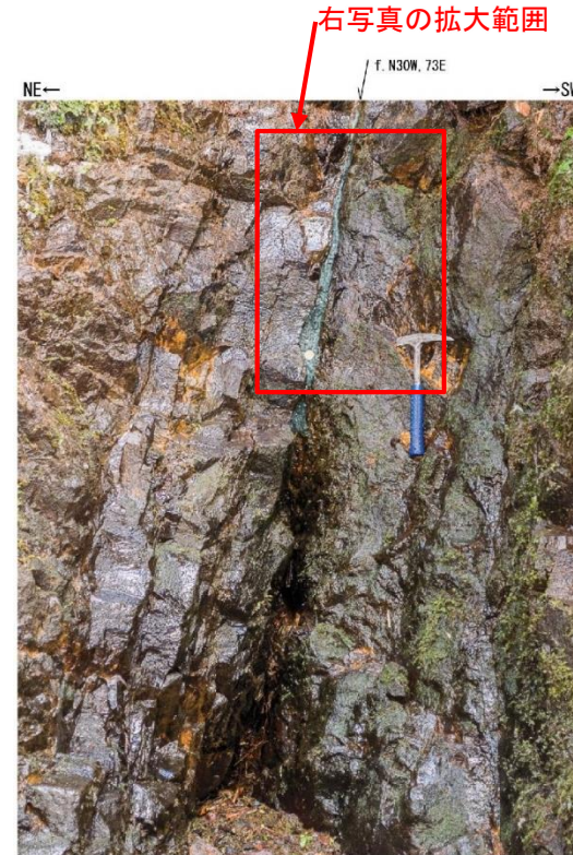
Loc. y110 東通村老部川右岸 泊層安山岩質溶岩中の小断層。
