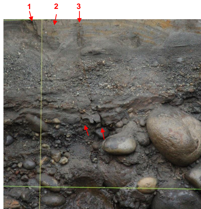
① 小断裂1~3 小断裂は礫層中で不明瞭となる
