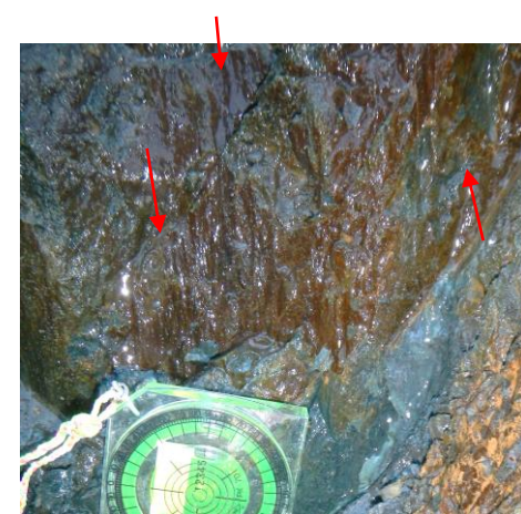
T6(2)トレンチ北面 ④破碎部の条線
