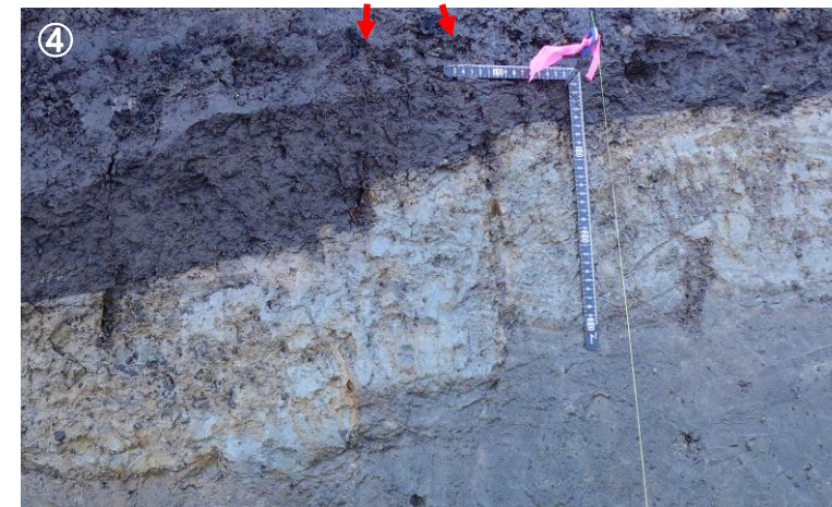
④ 洞爺火山灰層に見掛け鉛直変位約6cmの変位を与える小断裂
