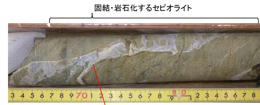
不規則な形状に晶出した石英(玉髓)脈 F-4断層: K-1孔深度7.63~7.88mコア 拡大写真①(平成29年撮影)
