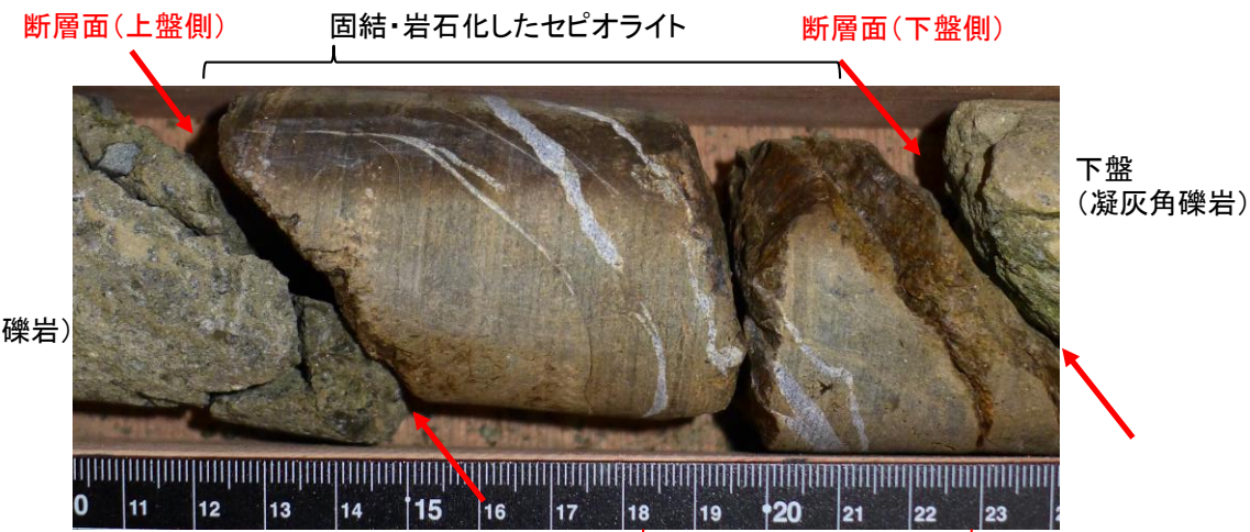
断層面と概ね平行な石英(玉髓)脈 H-3(F-3)断層: B-2e孔, 深度40.50~20.64mコア写真(平成29年撮影)
