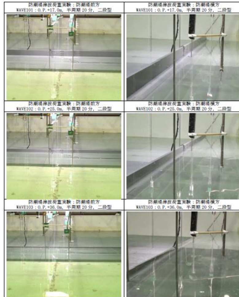
写真 2-3 実験状況 (津波荷重実験)
