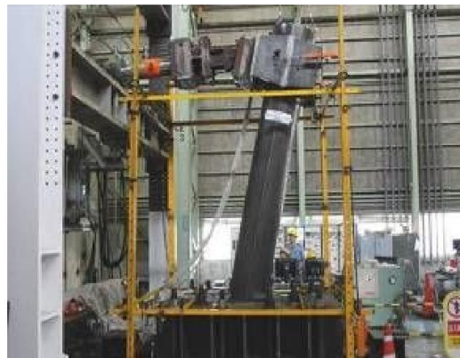
第 5-38 図 最大荷重時座屈状況
