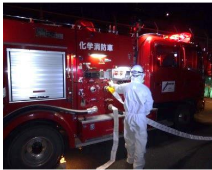
ポンプ起動操作（夜間）
