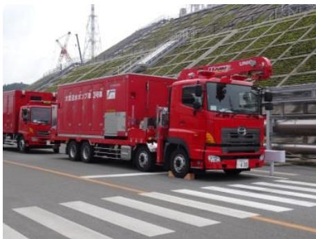
大型送水ポンプ車
