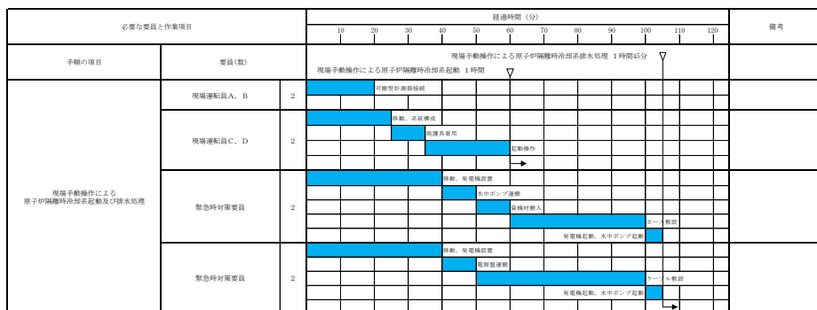
図3.2-6 現場手動操作による原子炉隔離時冷却系起動のタイムチャート*
