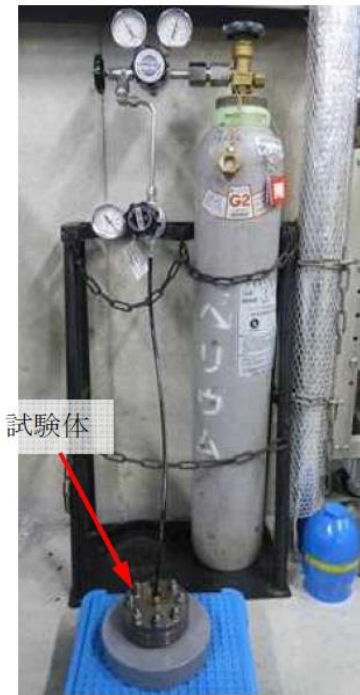
図5 He気密確認試験状況
