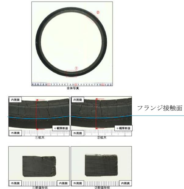
図5 200℃・168hr 試験後の試験体外観
