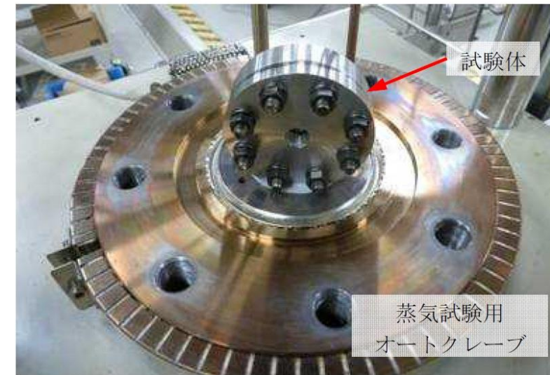
図4 蒸気暴露試験体設置状況
