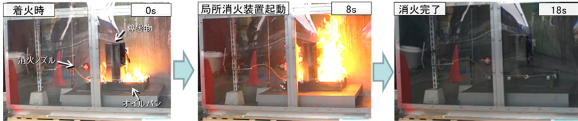
図3. グローブボックス内消火試験の経過
