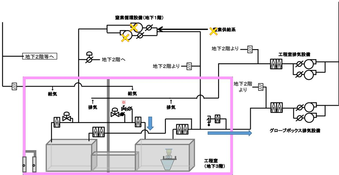
※：通常時は閉である自力式吸気弁が、グローブボックスの過負圧により開となる。
