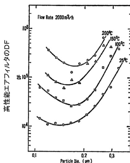
第1. 8-3図 高性能エアフィルタの温度と捕集効率の関係
