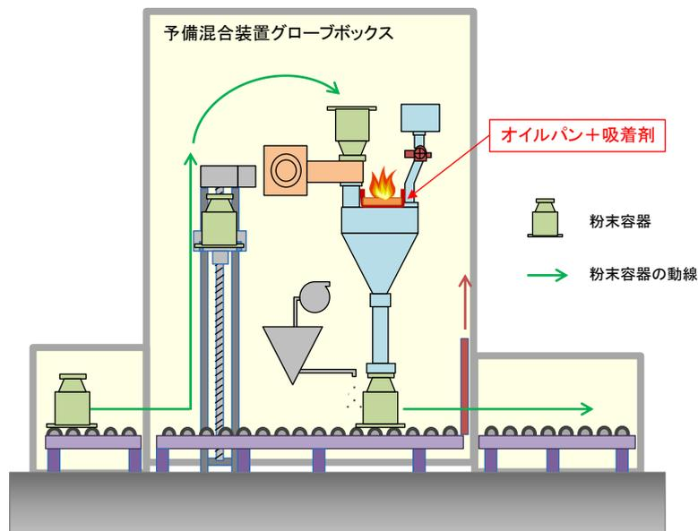
第1図 予備混合装置グローブボックスにおける核燃料物質の取扱い
