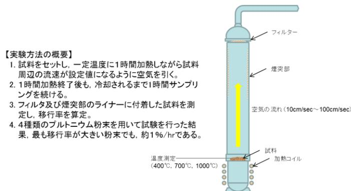
第 1. 7. 1-1 図 文献による実験の概要図
