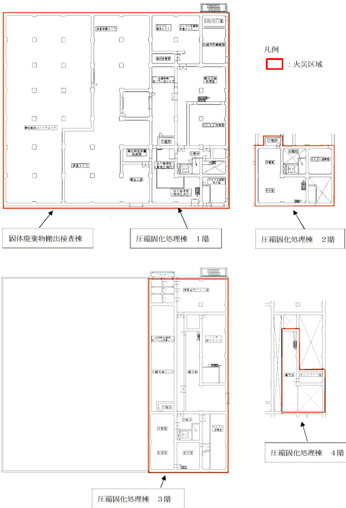
第8-1図 廃棄物搬出設備の火災区域(1/2)
