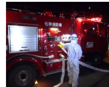
ポンプ起動操作 (夜間)
