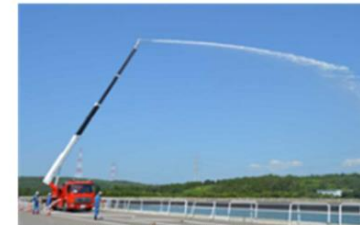
大型化学高所放水車による放水状況
