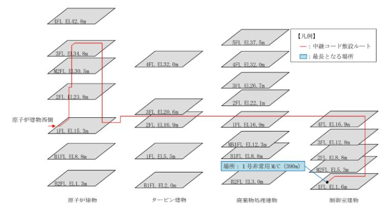
(注1) 屋内は、原子炉建物西側の入口から最長となる制御室建物1階までの390mを、班数が最大となる原子炉補機代替冷却系による除熱手順の4班がそれぞれ敷設する場合、これを満足する中継コード8台(2台×4班、200m/台)を緊急時対策所近傍の免震重要棟に保管する。
