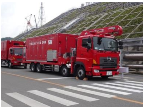
大型送水ポンプ車
