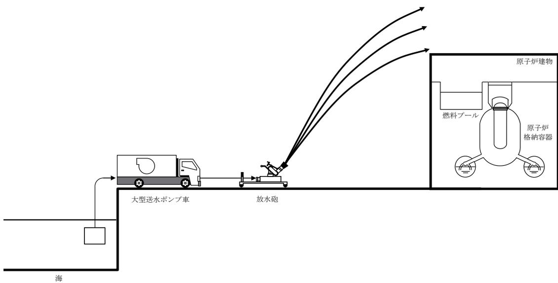
第 3.11-4 図 燃料プールの冷却等のための設備系統概要図
