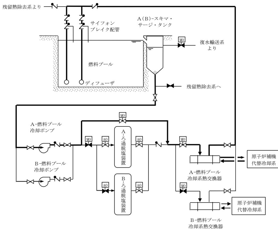
第 3.11-6 図 燃料プールの冷却等のための設備系統概要図
