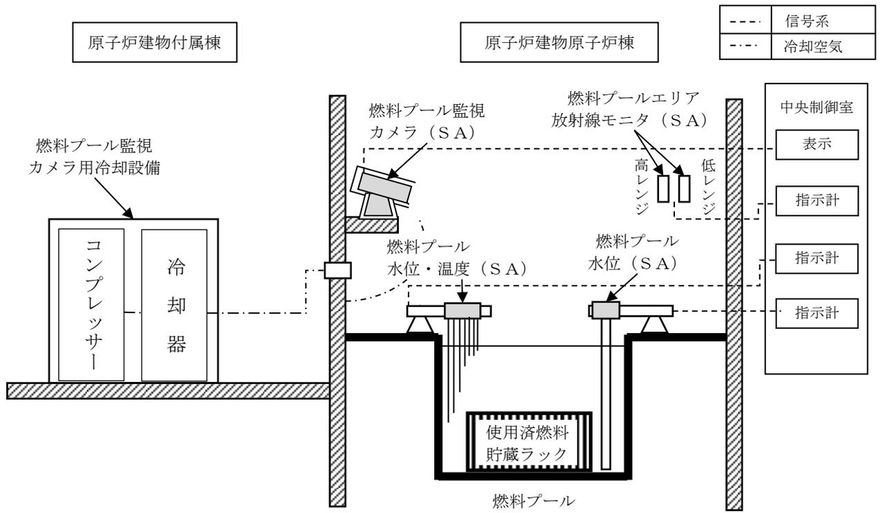
図 3.11-12 燃料プール監視設備の系統概要図
