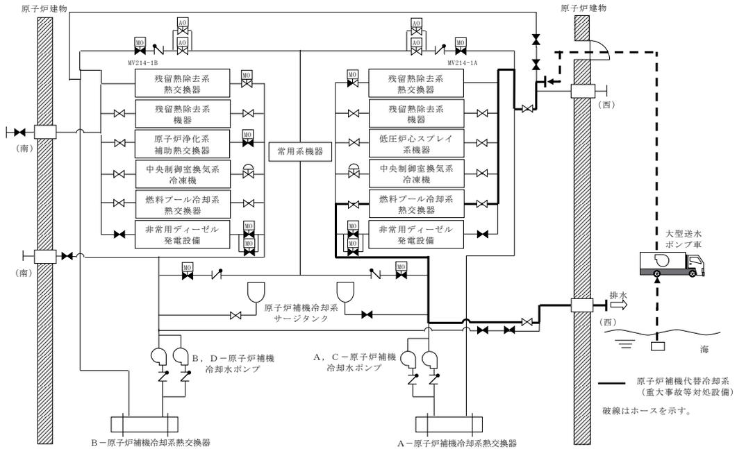
第 3.11-10 図 燃料プールの冷却等のための設備系統概要図
