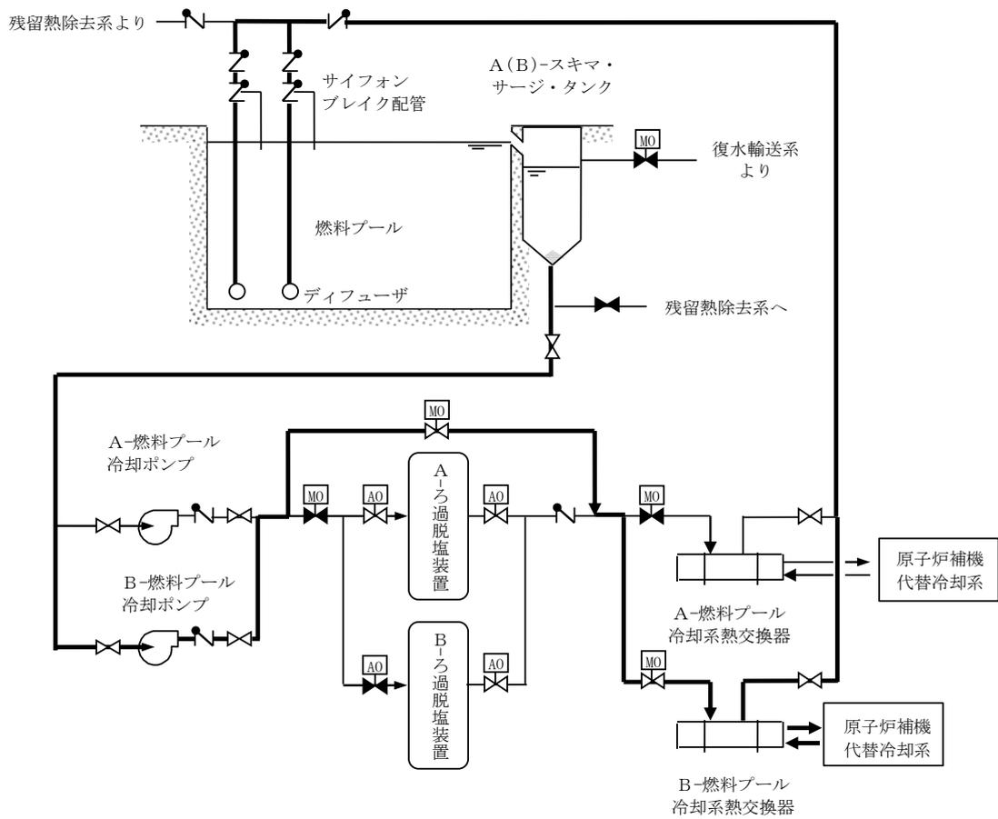
第 3.11-7 図 燃料プールの冷却等のための設備系統概要図
