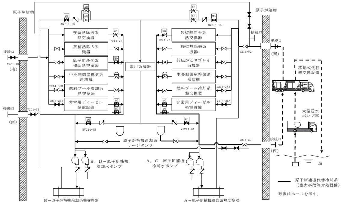
第 3.11-8 図 燃料プールの冷却等のための設備系統概要図
