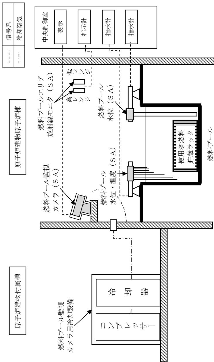
第 3.11-5 図 燃料プールの冷却等のための設備系統概要図
