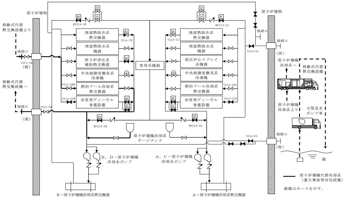
第 3.11-9 図 燃料プールの冷却等のための設備系統概要図
