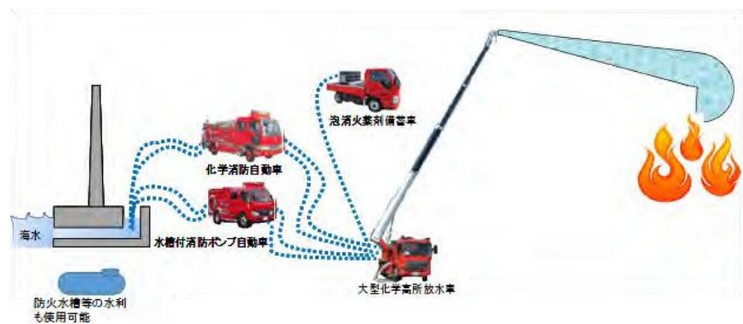
図 8-1 大型化学高所放水車による泡消火
