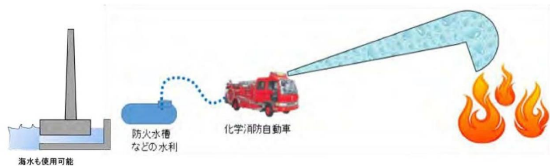
図 8-2 化学消防自動車による泡消火
