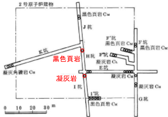
平板載荷試験位置図(2号試掘坑平面図)
