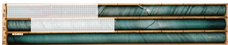
凝灰岩ボーリングコア写真の例 (No.B-2(2006), G.L.-87.41~88.12, -88.48~-90.00m)
