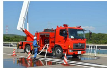
大型化学高所放水車の遠隔操作状況
