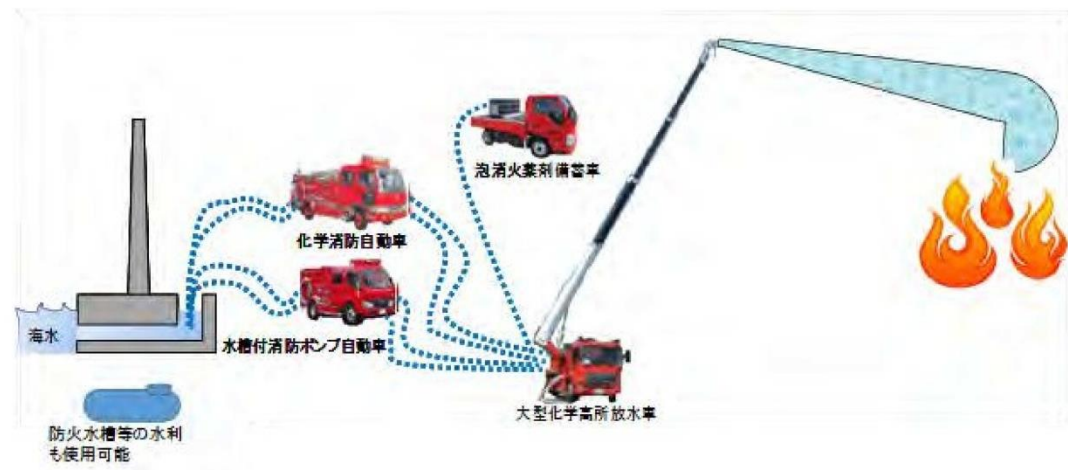
図 8-1 大型化学高所放水車による泡消火
