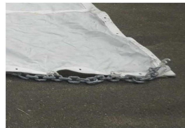
端部拡大写真 (重り (チェーン))
