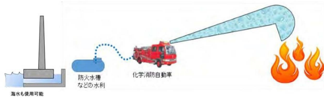
図 8-2 化学消防自動車による泡消火
