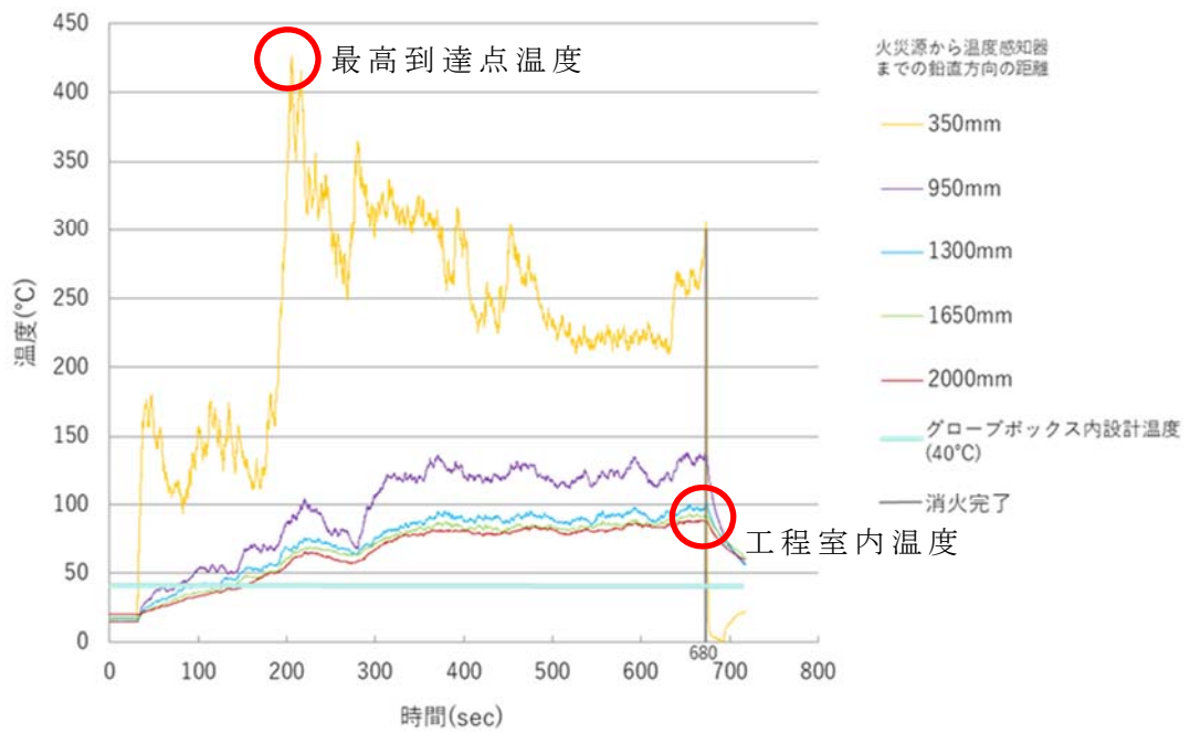
第 2 - 1 図 グローブボックス内火災の模擬試験実施時の温度変化
