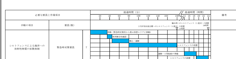
図 3.12-6 海洋への放射性物質の拡散抑制 (シルトフェンス) のタイムチャート※
