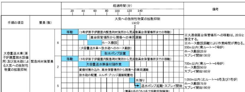
図 3. 12-5 大気への放射性物質の拡散抑制のタイムチャート※
