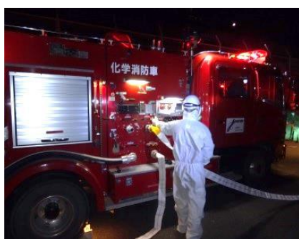
ポンプ起動操作（夜間）
