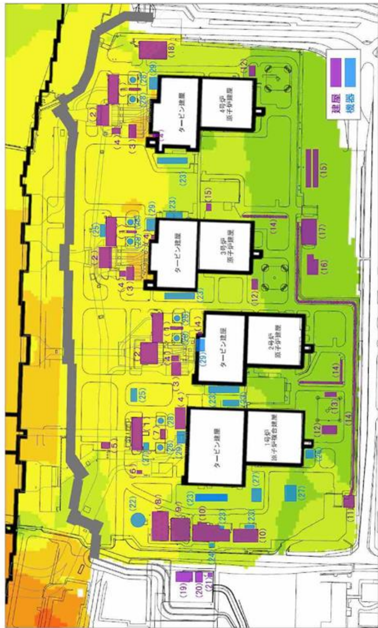
第2.5-14-4-2図 漂流物調査結果（発電所構内荒浜側防潮堤内敷地詳細）
