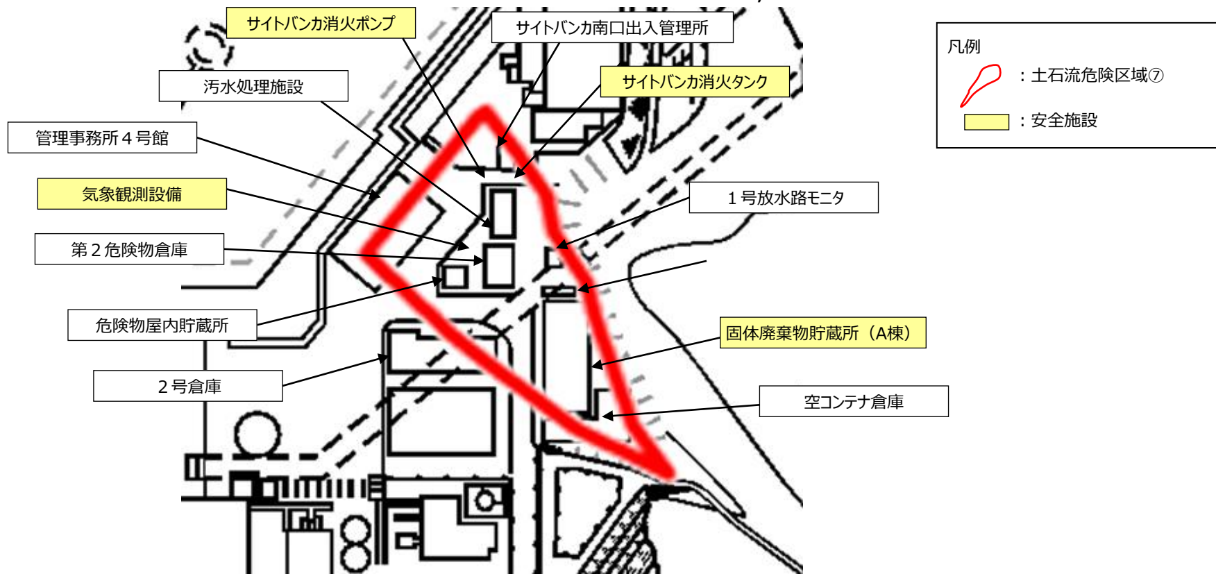
土石流危険区域⑦に含まれる設備等
