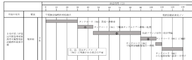
図 2.2-3 5号炉原子炉建屋内緊急時対策所用可搬型電源設備の給油時間
