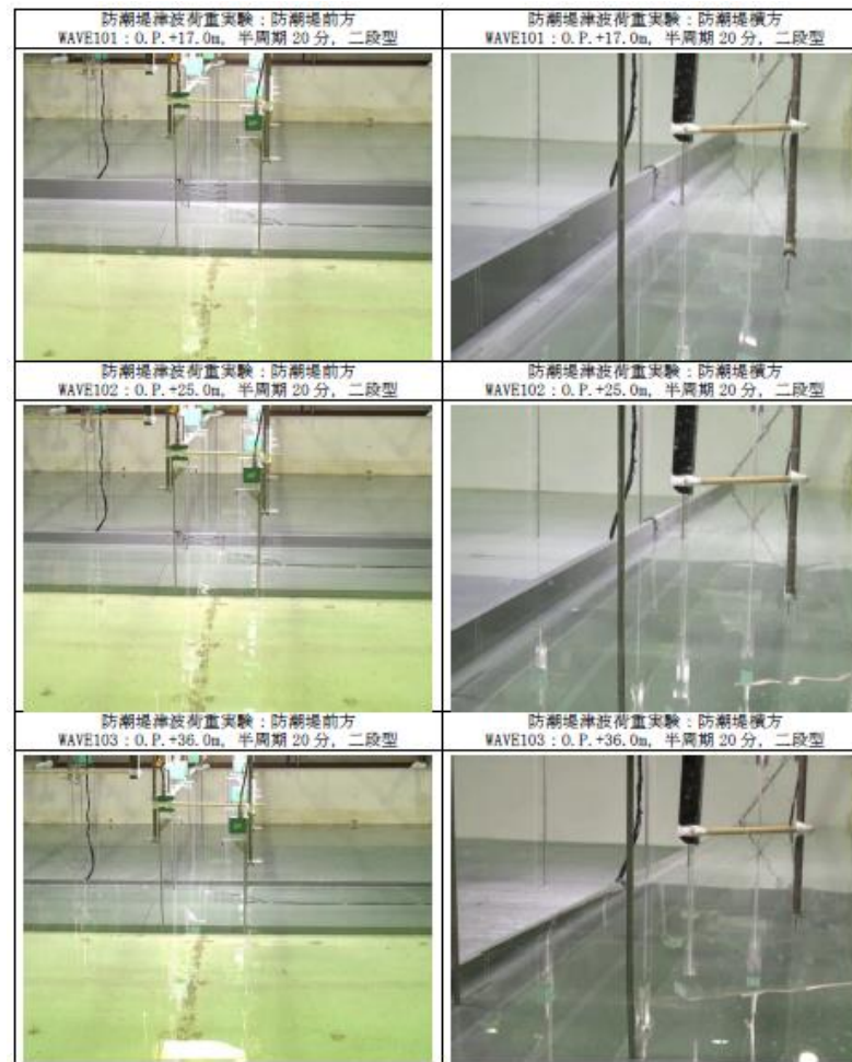
写真 2-3 実験状況 (津波荷重実験)
