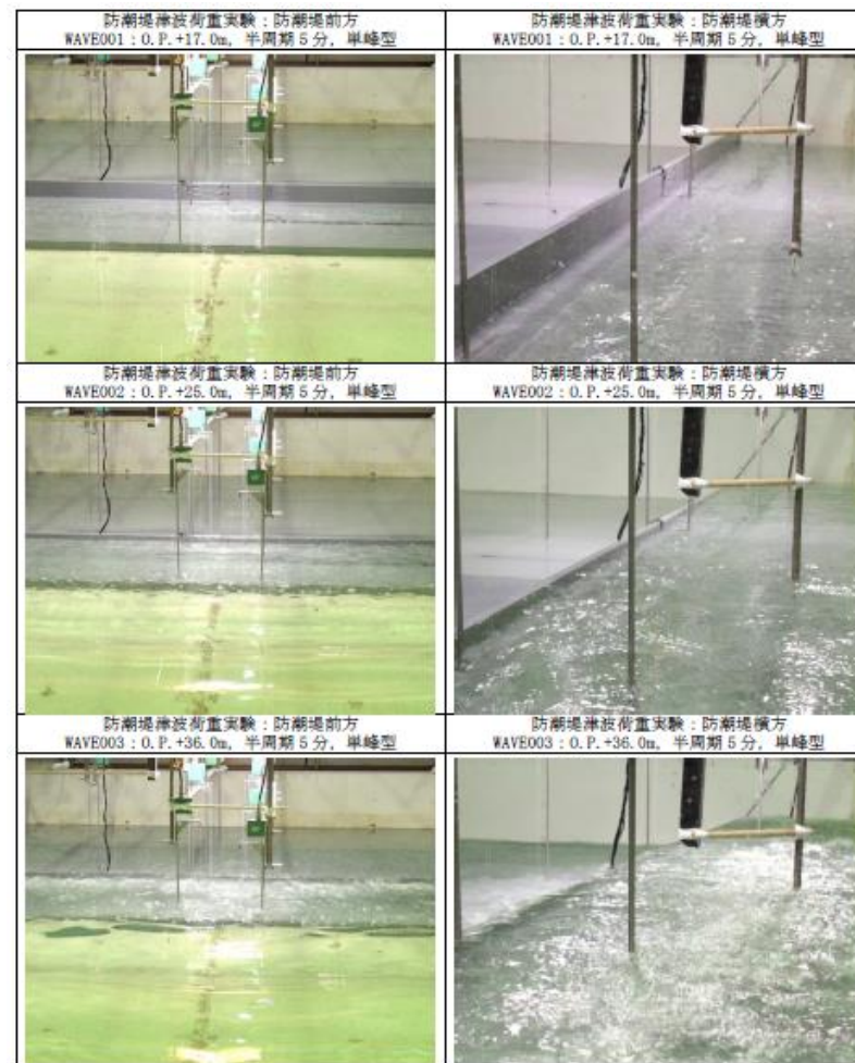
写真 2-1 実験状況 (津波荷重実験)
