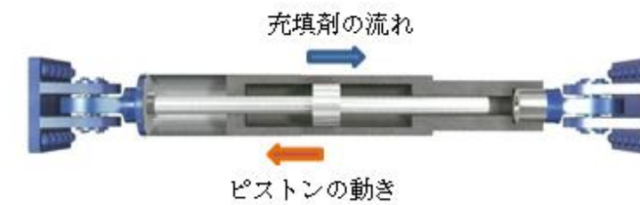
第2-4図 単軸粘性ダンパの動作原理
