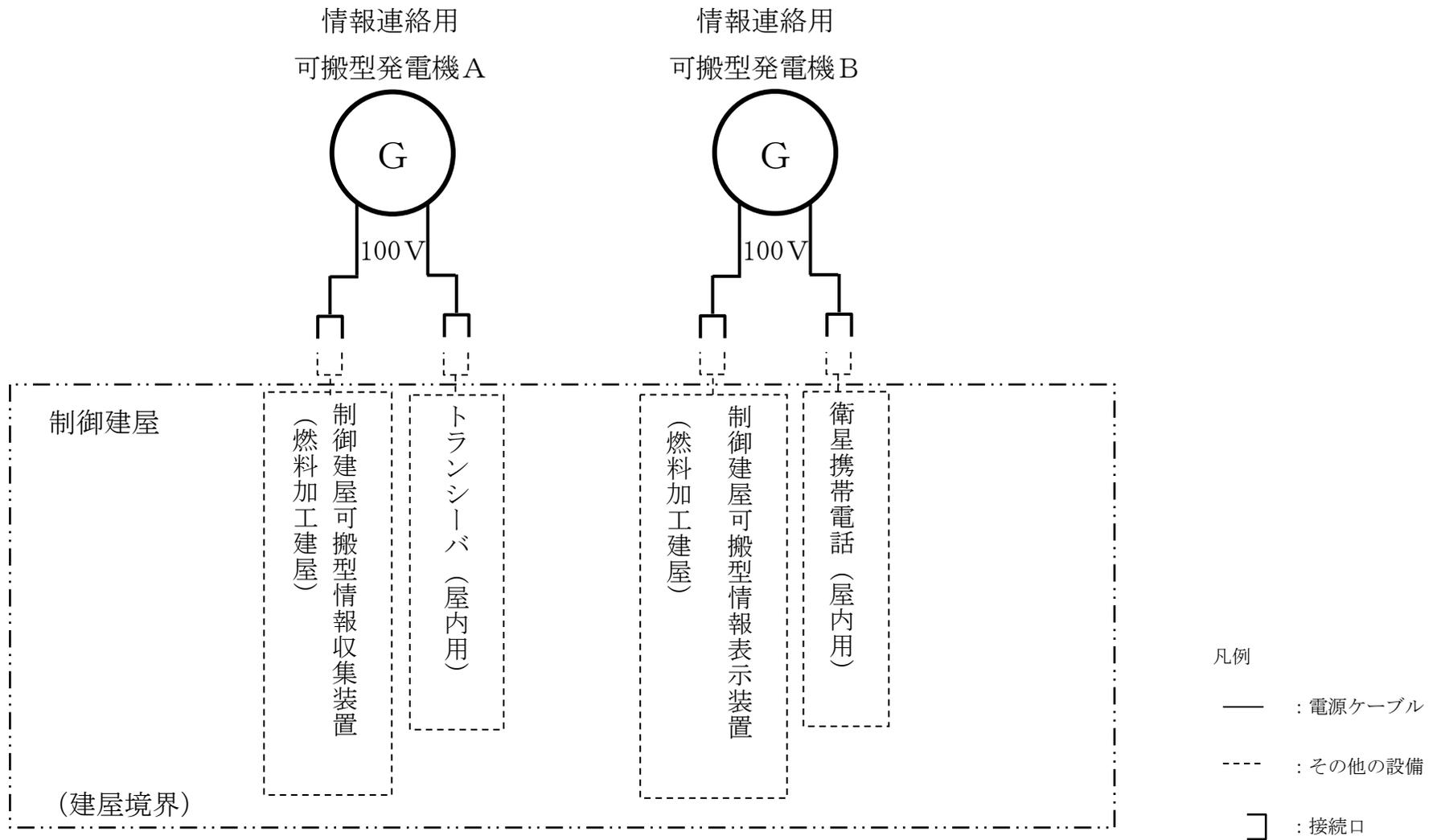
第 32. 2 図 全交流電源喪失時において重大事故等に対処するための電力を確保するための設備の系統図
