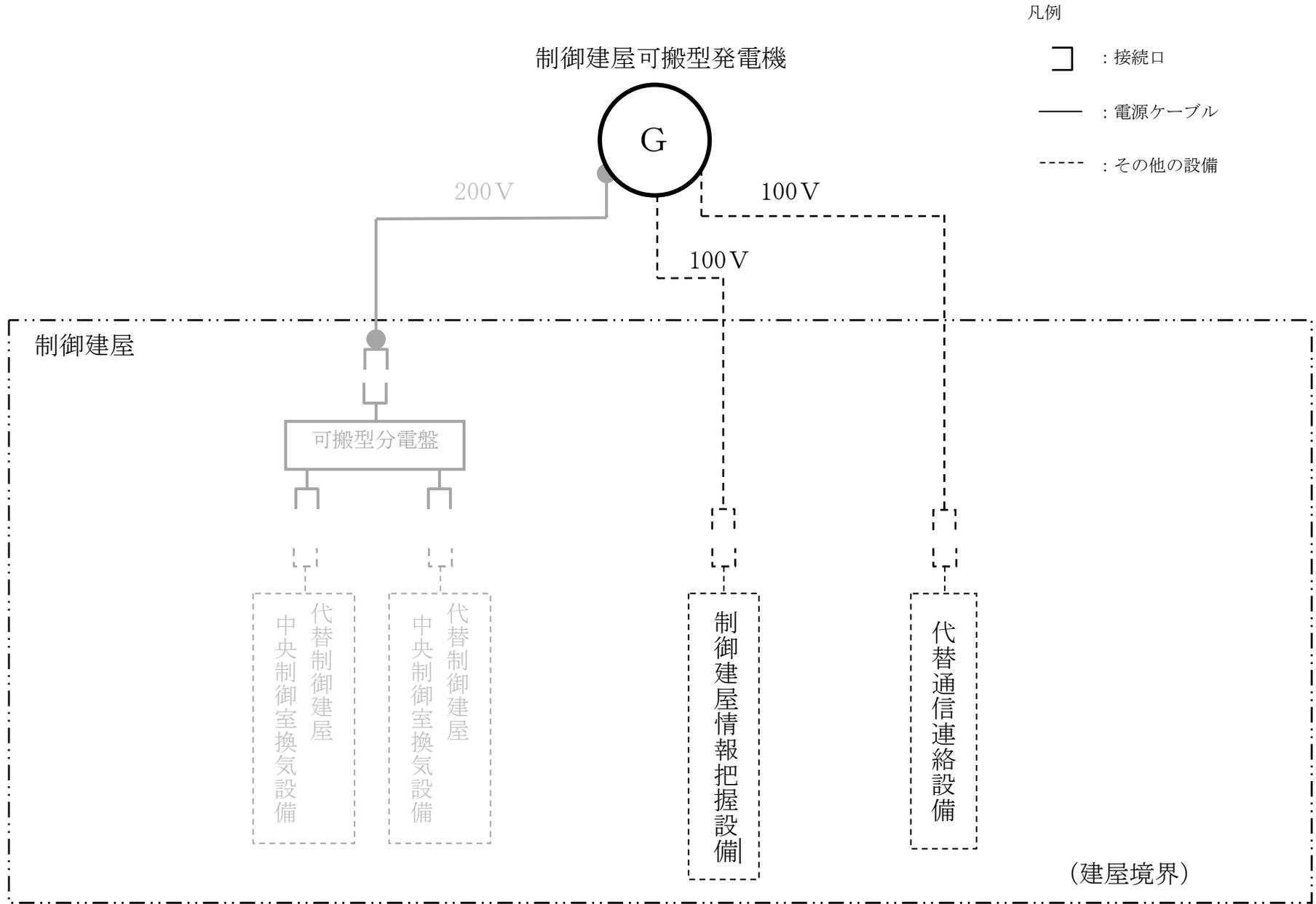
第 32. 3 図 全交流電源喪失時において重大事故等に対処するための電力を確保するための設備の系統図
