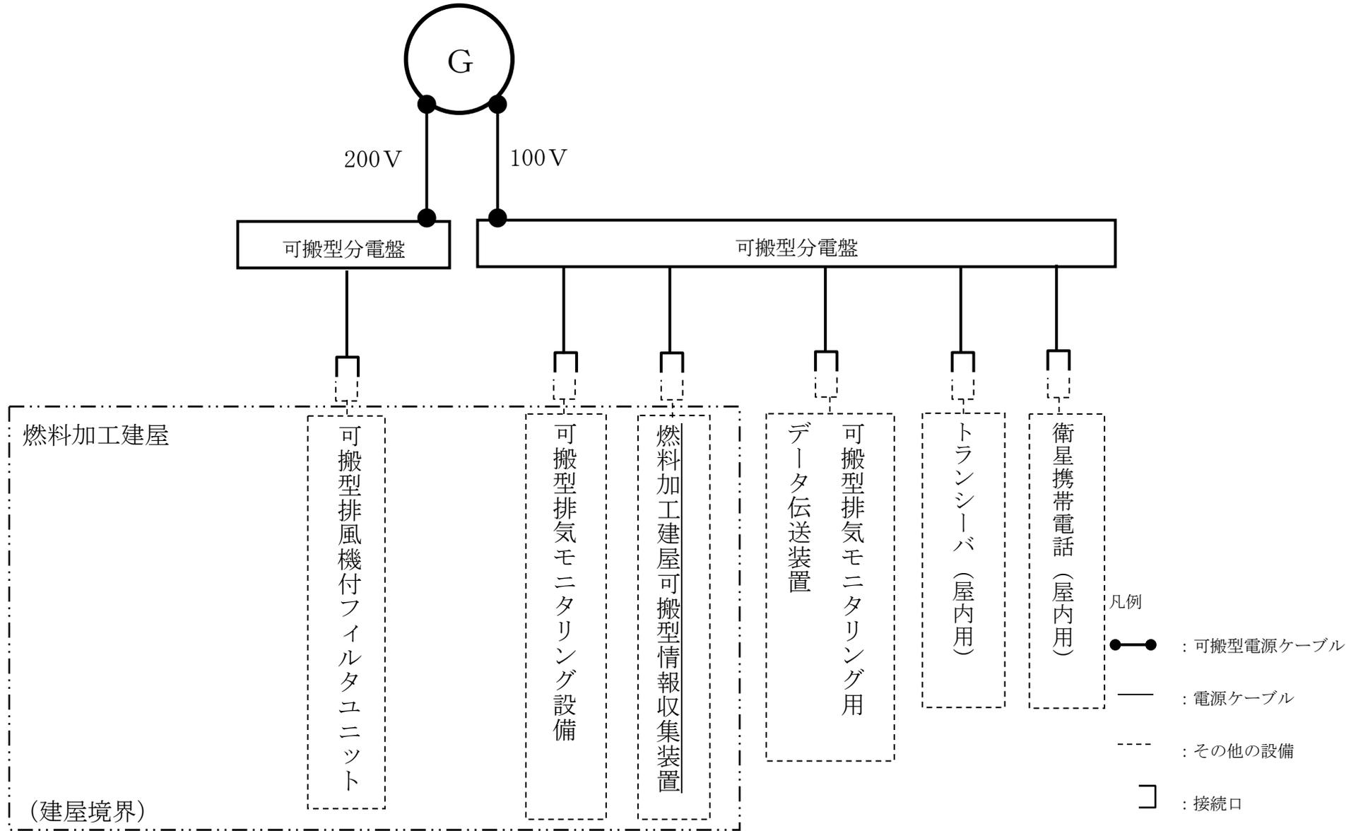
第 32. 1 図 全交流電源喪失時において重大事故等に対処するための電力を確保するための設備の系統図
