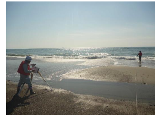
海岸線地形測量実施状況 (汀線部)
