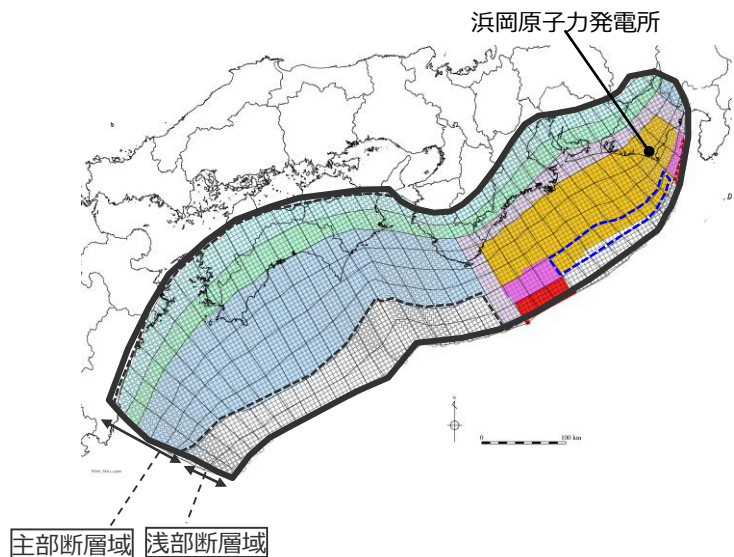
検討波源モデル B-1 (プレート境界面浅部・東海断層系)
