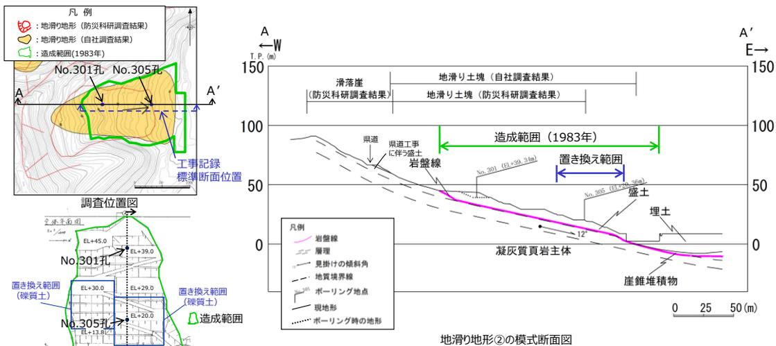
図-23 地滑り地形②の模式断面図
