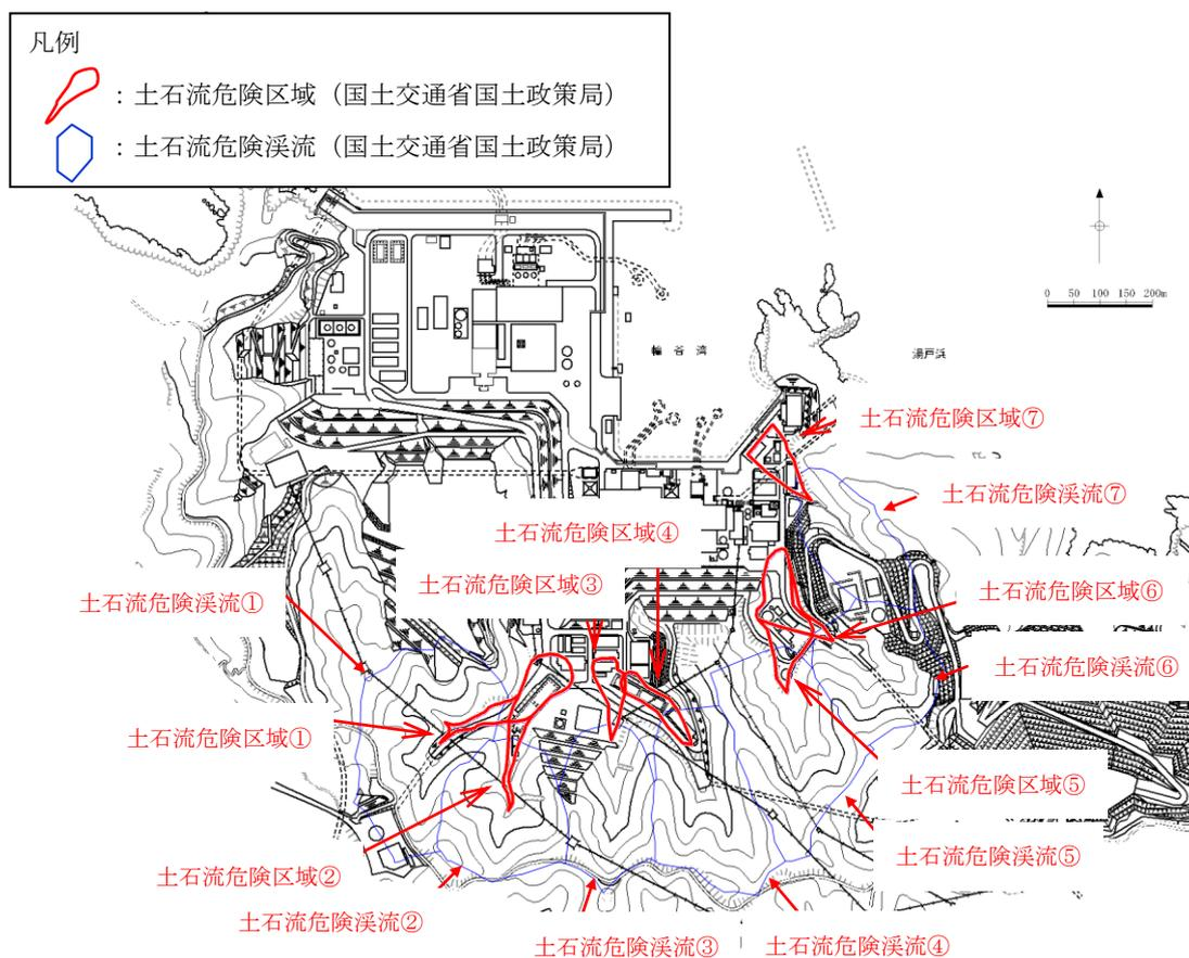
図-5 島根原子力発電所周辺における土石流危険区域
