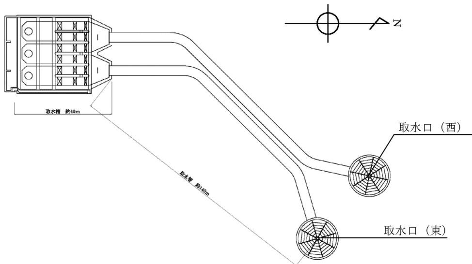
第4-6図 取水口～取水ピット平面図
