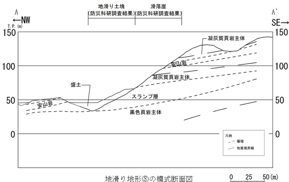
図-30 地滑り地形③の模式断面図
