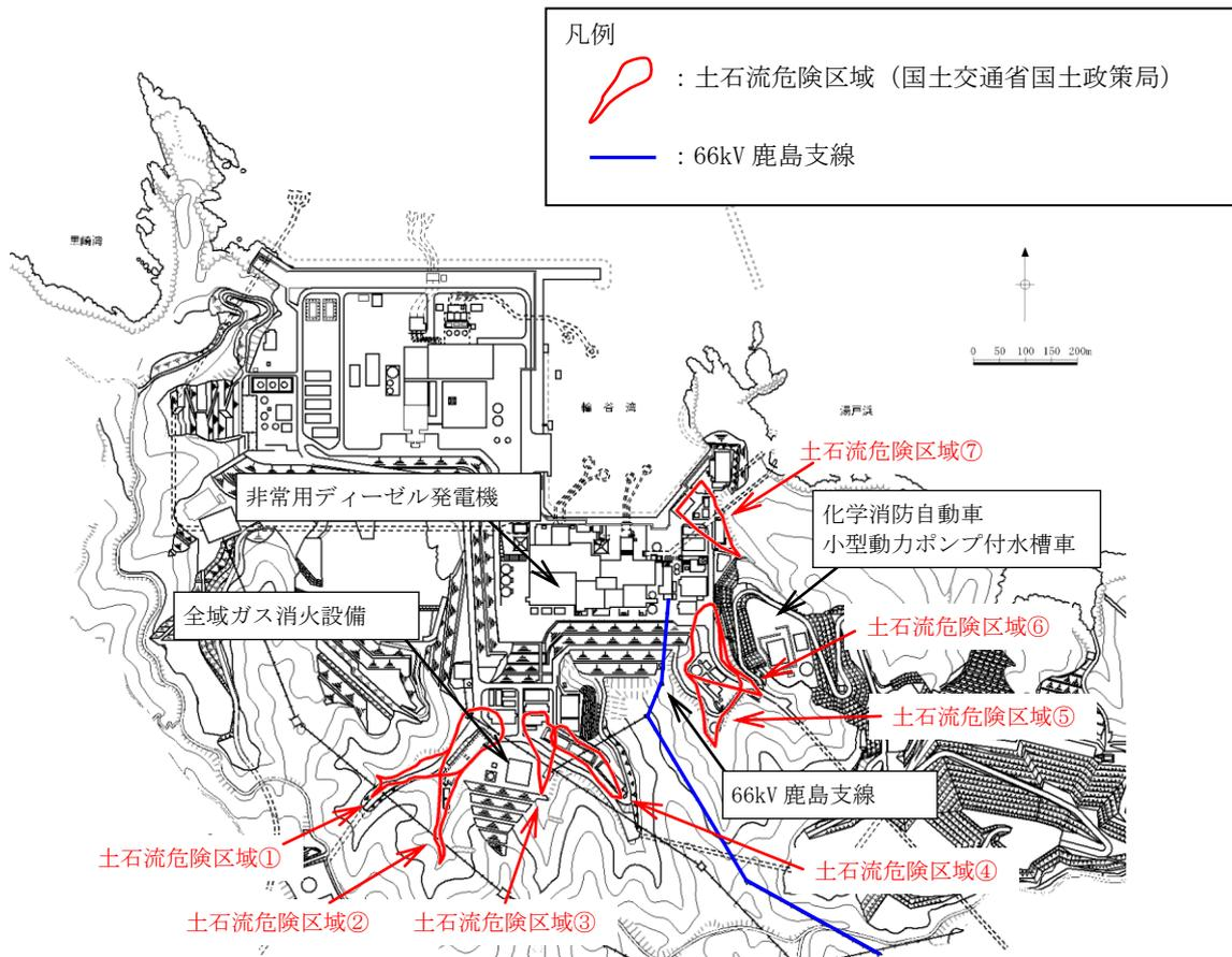
図-21 島根原子力発電所周辺における土石流危険区域
