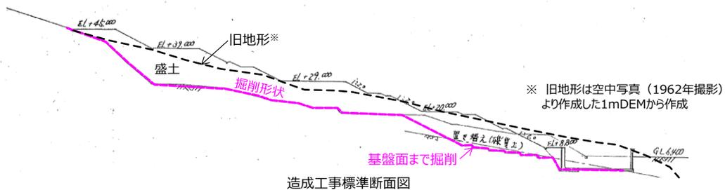
地滑り土塊とされる範囲のうち EL45m 以下の範囲については、1983 年に土地造成工事が行われている。当時の工事記録によると、地滑り土塊とされる箇所は、地滑り土塊に相当する土砂を撤去したうえで、盛土を施している。また、法尻部付近では基盤面まで段切り掘削後に良質土で置換盛土を行っている。
