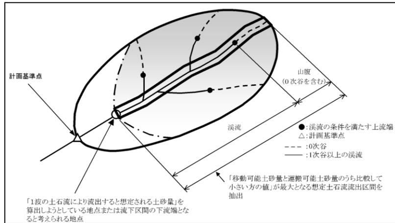
図-19 1波の土石流により流出すると想定される土砂量算出のイメージ図
