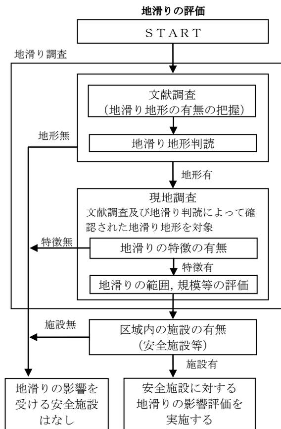
図-1 地滑りの影響評価フロー図
