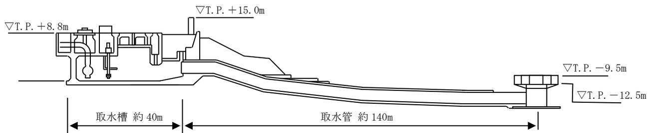
第4-7図 取水口～取水ピット断面図
