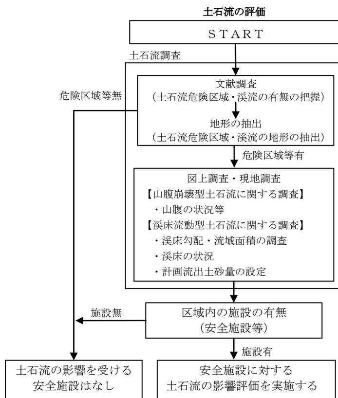
図-4 土石流の影響評価フロー図
