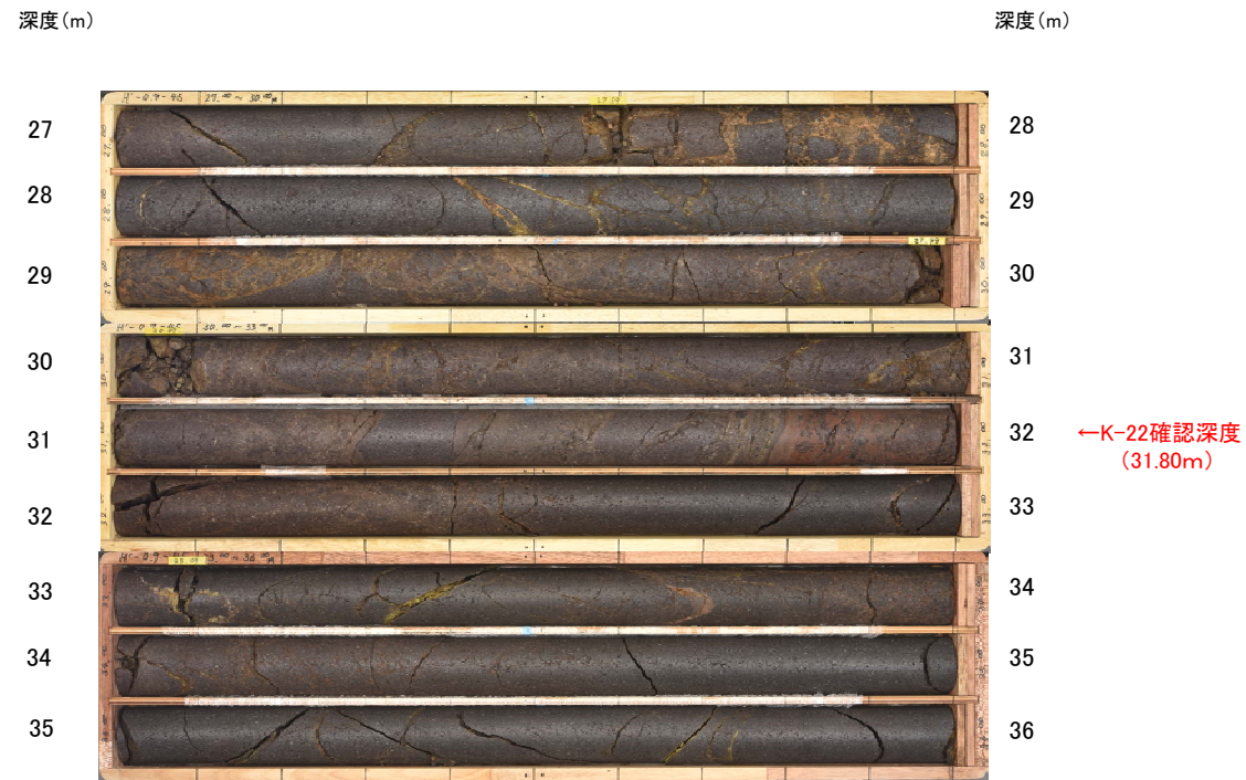
H' -0.9-45孔(掘進長40.00m, 傾斜45°)
