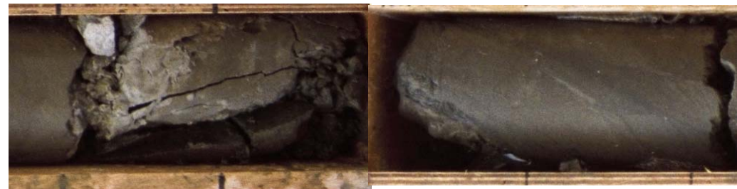
礫状の破碎部 破碎幅:約6cm
