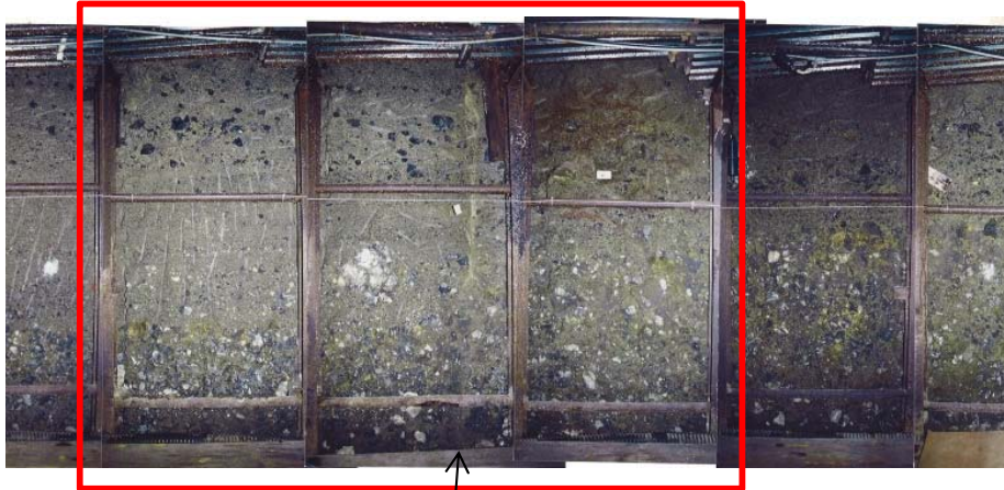
df-4断層 見掛けの鉛直変位量:約0.7m
