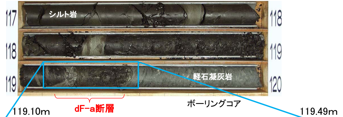
【P-1孔】 深度119.44m 断層面の傾斜約45°
