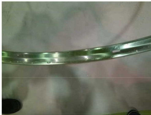
別添6-1図 中型乾式キャスク 金属ガスケット状況 [2]
