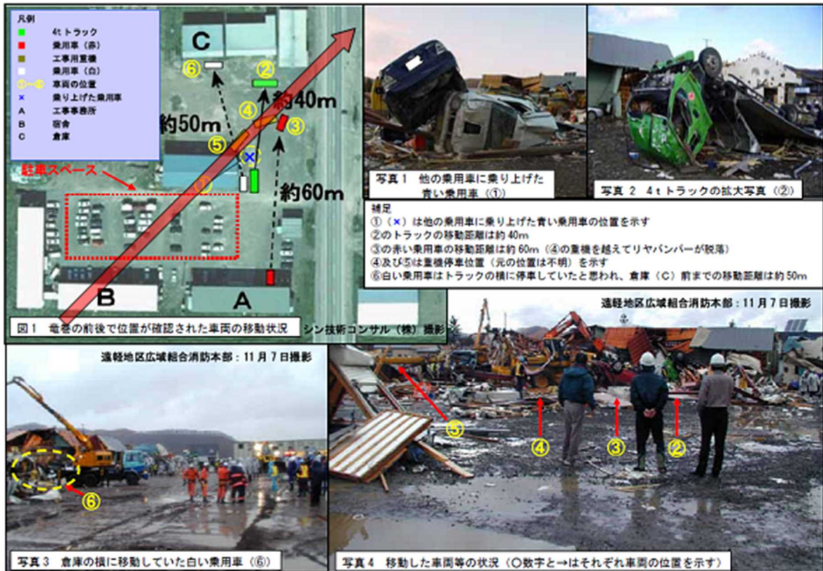
佐呂間竜巻(2006. 11. 7)による被災状況: 工事事務所敷地内の車両被災 (竜巻経路 → を追加)
