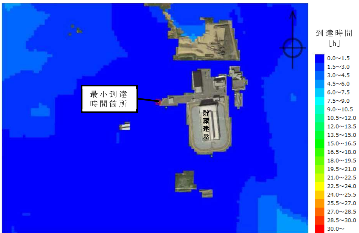
第 29 図 (3) 発火点 2 (発火時刻 : 10:00) に対する火災到達時間分布 (下の図は同拡大図及び最小到達時間発生箇所)
