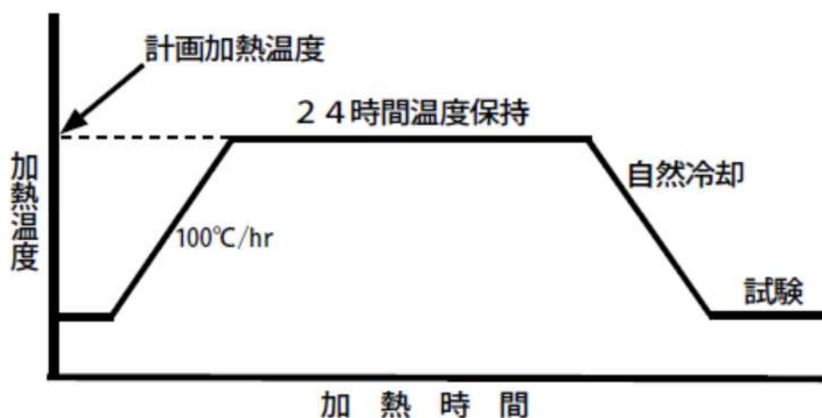
別添 1 - 1 図 コンクリート供試体加熱パターン
