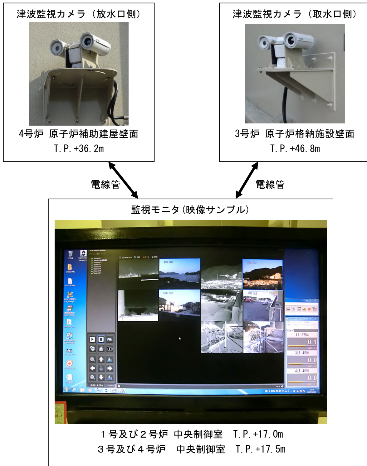
図 3-3-2 津波監視カメラ設備構成イメージ
