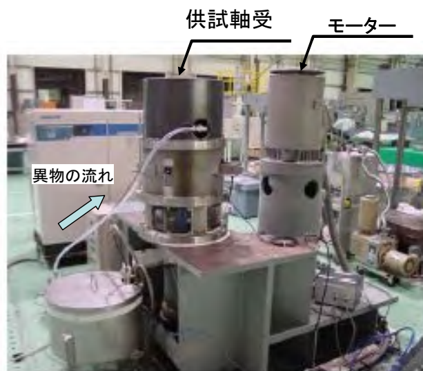
図-2 海水ポンプ軸受摩耗試験装置
