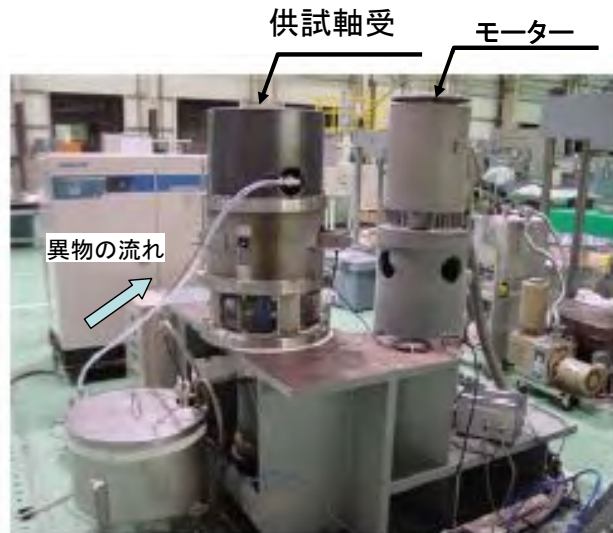
図-2 海水ポンプ軸受摩耗試験装置
