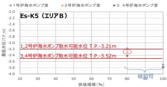
図10 崩壊規模のパラメータスタディ結果 (施設影響の確認)
