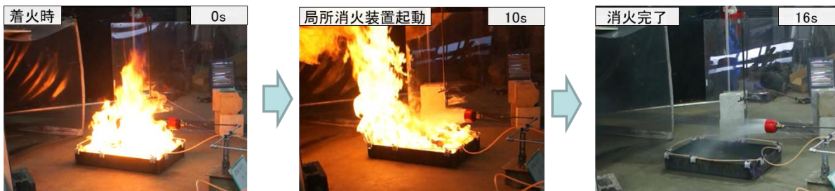
図 6. 開放空間消火試験 (代替ハロン) の経過
