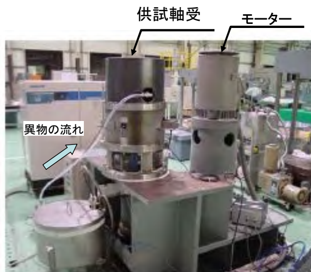
図-2 海水ポンプ軸受摩耗試験装置
