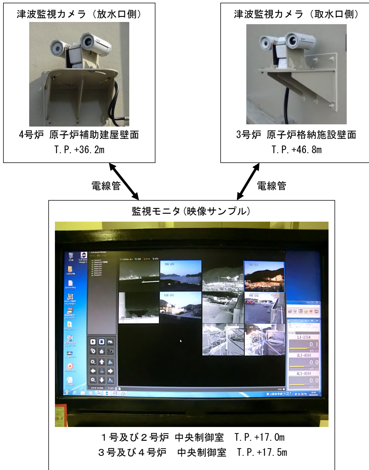
図 3-3-2 津波監視カメラ設備構成イメージ
