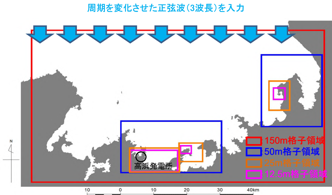
図 15 正弦波入力による検討概要（計算領域及び空間格子間隔）
