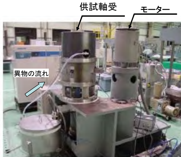
図-2 海水ポンプ軸受摩耗試験装置
