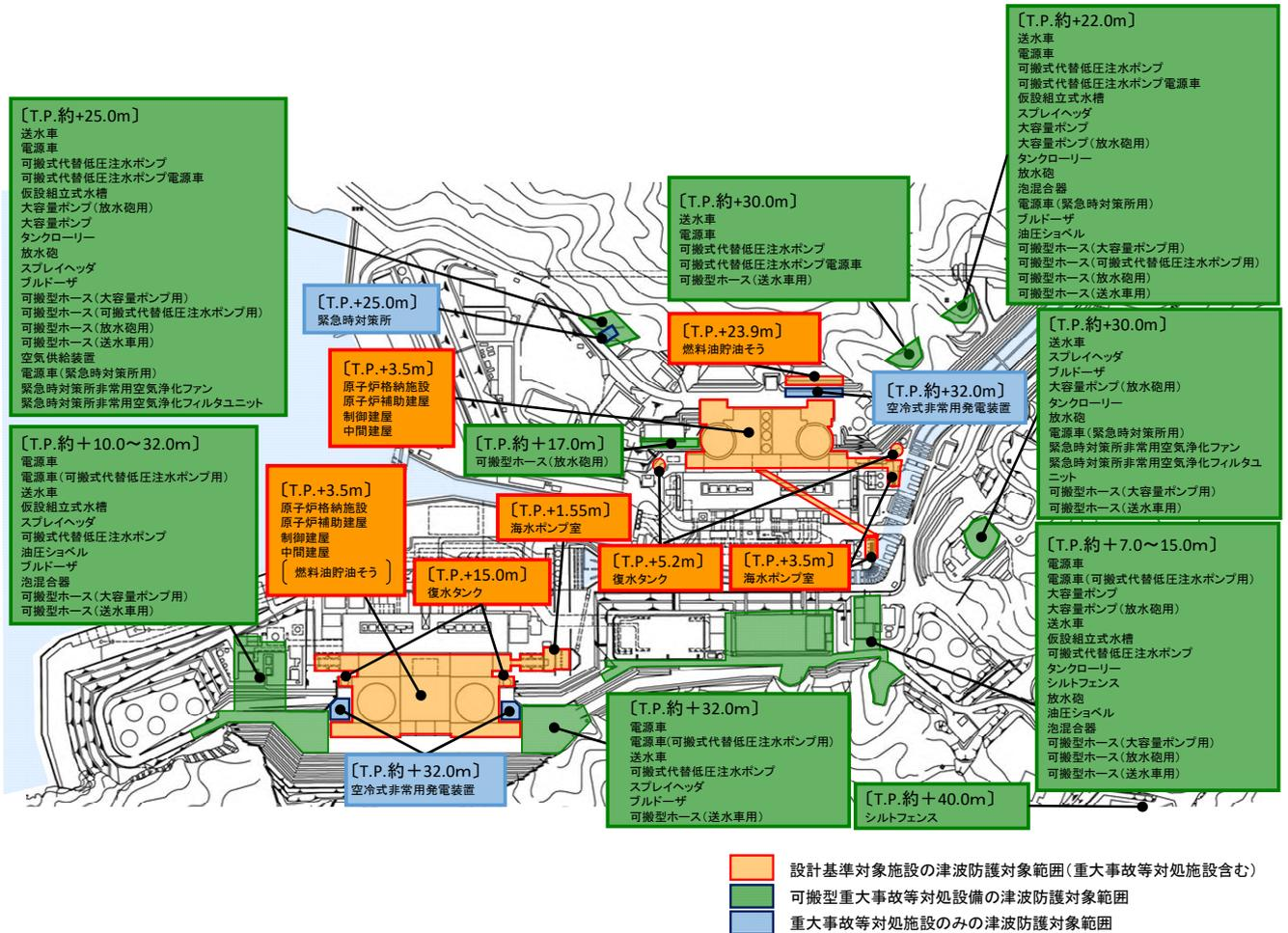
図-2-4-1 高浜 1～4 号炉 浸水防護重点化範囲
