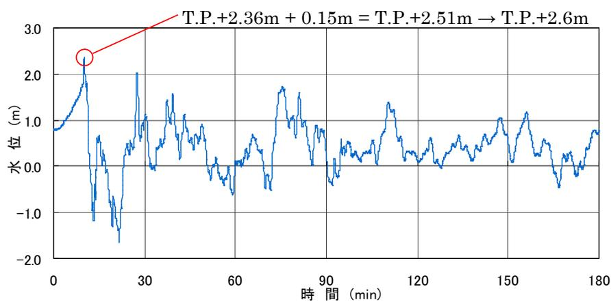
図-1-6-2 入力津波の時刻歴波形 (1/5)
