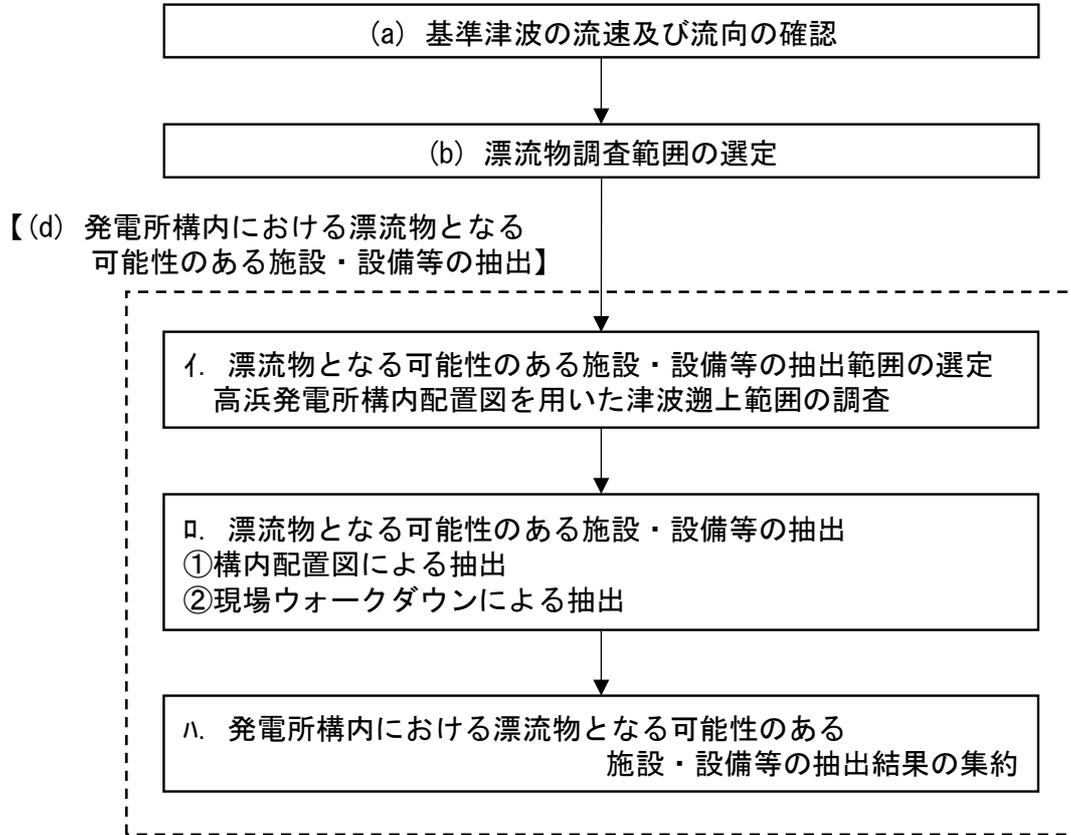
図-2-5-11 発電所構内漂流物抽出フロー
