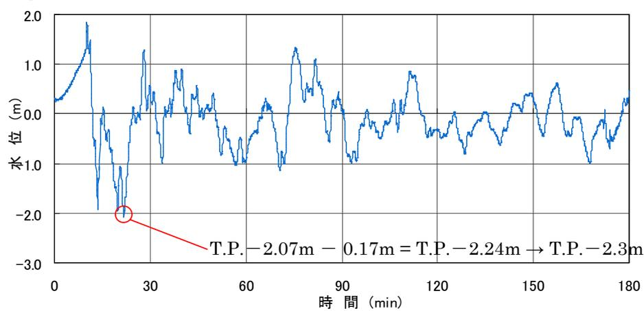
図-1-6-2 入力津波の時刻歴波形 (4/5)
