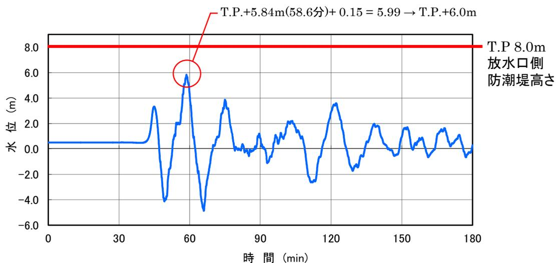
図-2-2-53 3号及び4号炉 放水口前面津波波形
