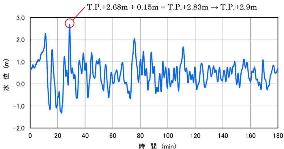
図-1-6-2 入力津波の時刻歴波形 (2/5)
