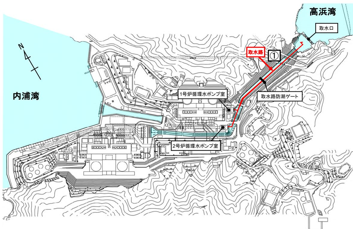
図-2-2-14 1, 2号炉海水取水系配置図
