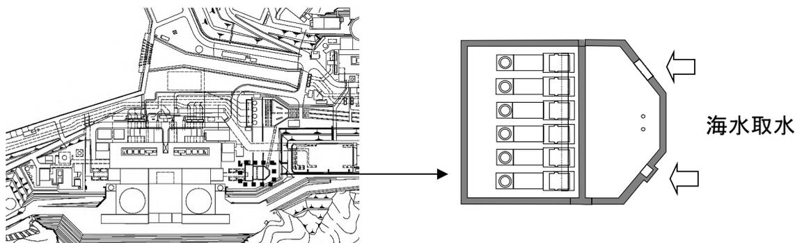
図-2-3-9 3,4号炉海水取水設備（平面図）
