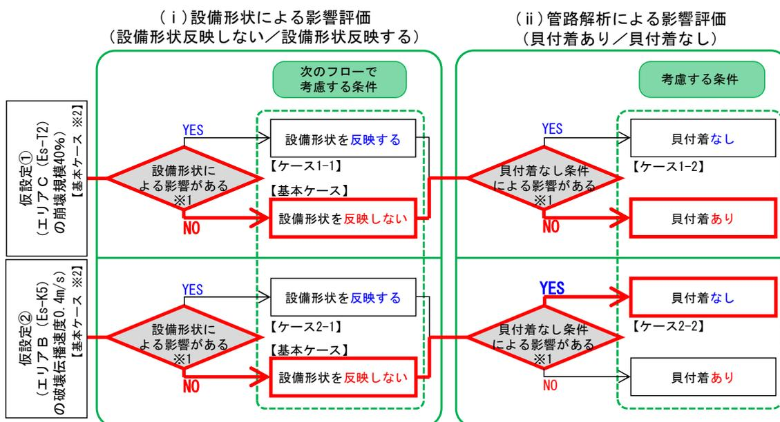
※1 各条件を考慮した方が1波目の水位低下量が小さくなる場合に影響があるとして次のフローでの解析に考慮する。
