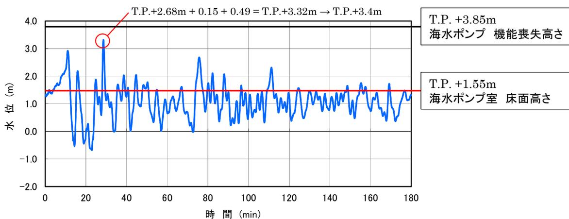
図-2-3-16 海水ポンプ浸水量評価波形
