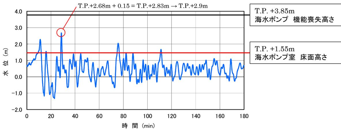
図-2-3-11 3, 4号炉海水ポンプ室前津波波形
