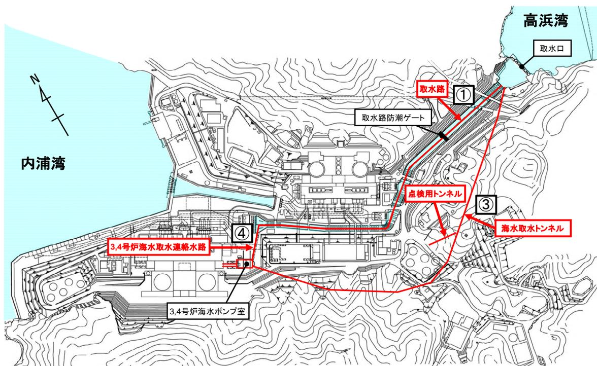
図-2-2-22 3, 4号炉海水取水系配置図
