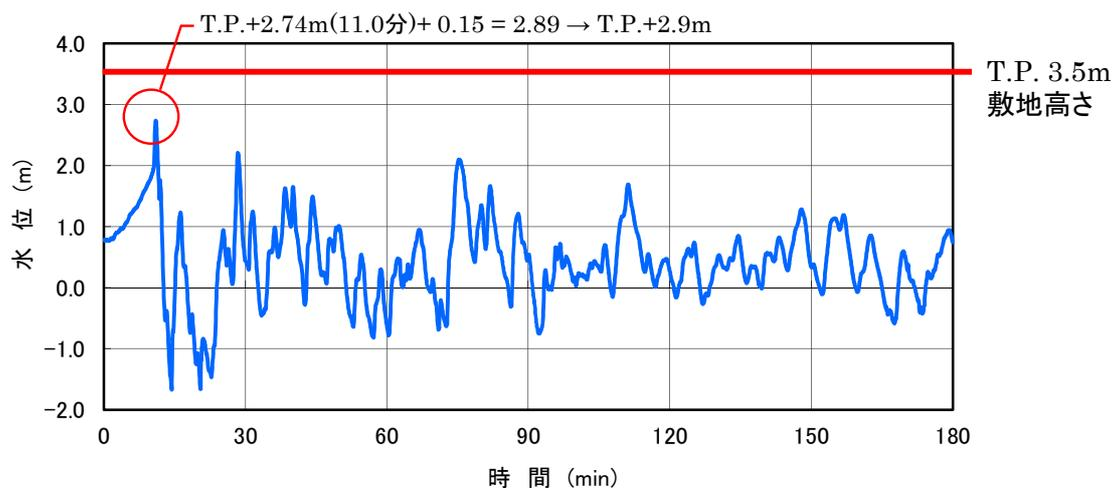
図-2-2-42 3,4号炉循環水ポンプ室 津波波形
