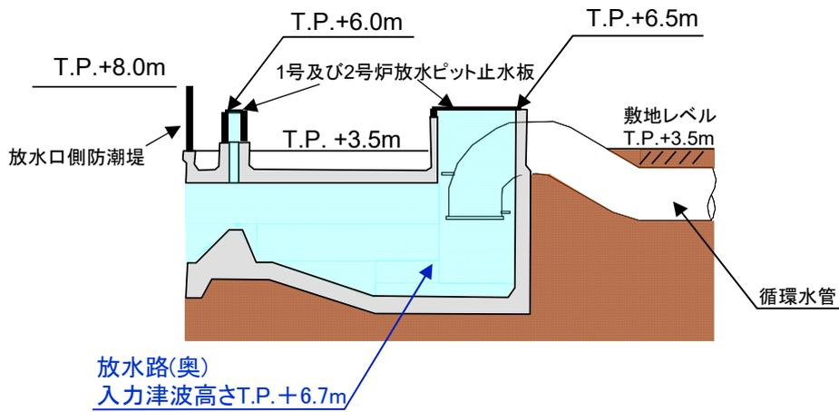
図-2-2-48 1号及び2号炉 放水ピット断面図
