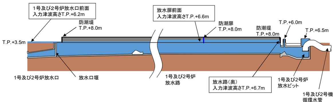
図-2-2-43 1号及び2号炉 放水路断面図
