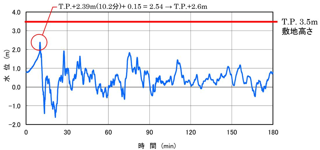
図-2-2-13 2号炉海水ポンプ室 津波波形
