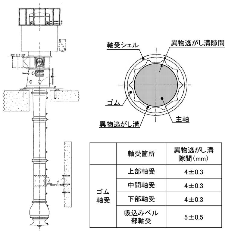
図-2-5-3(1/2) 海水ポンプ軸受構造図
