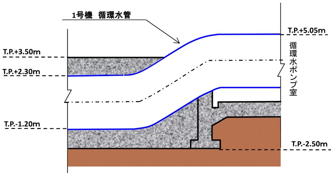
図-2-2-17 1号機循環水管埋設部 断面図②
