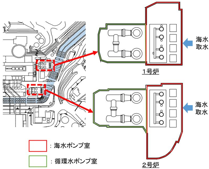
図-2-3-1 1号及び2号炉海水取水設備（平面図）
