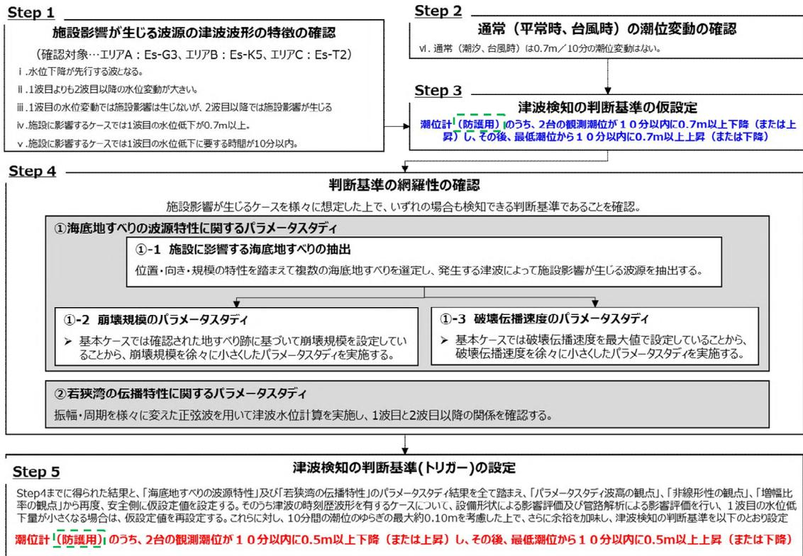
図-1-4-4 閉止判断基準の設定フロー
