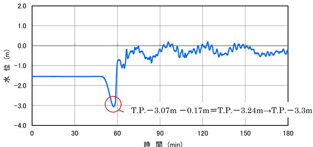
図-1-6-2 入力津波の時刻歴波形 (5/5)
