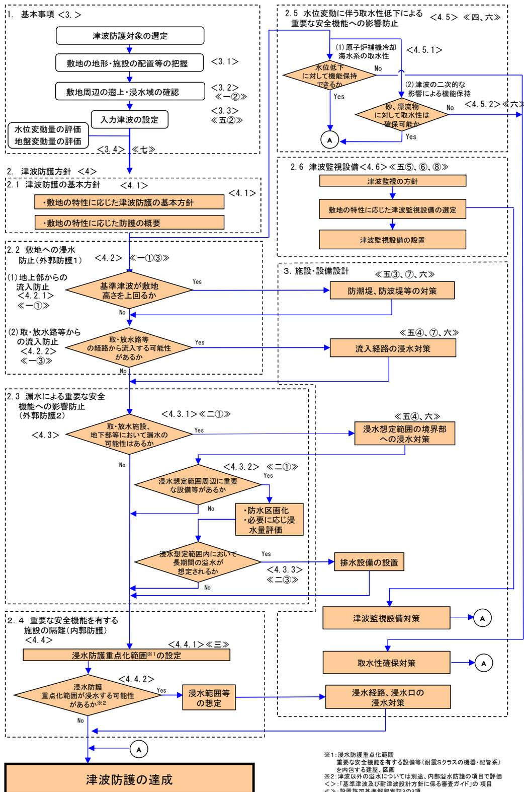
図1 耐津波設計の基本フロー
