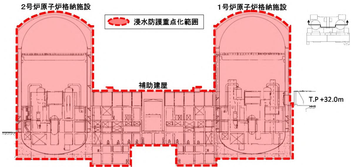
図-1-2-6 高浜 1, 2号炉建屋断面図及び浸水防護重点化範囲（東西方向）
