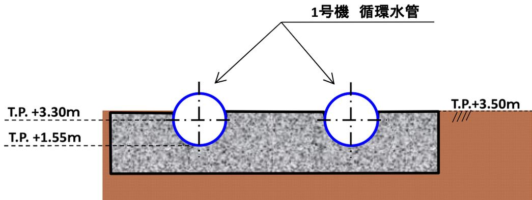
図-2-2-16 1号機循環水管埋設部 断面図①
