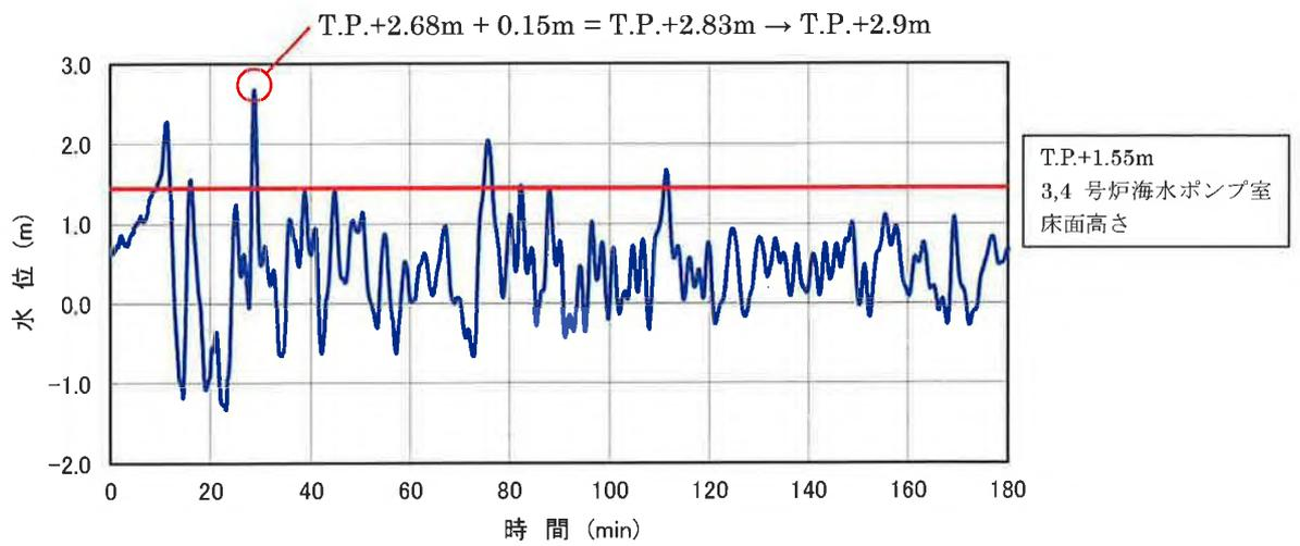
図-2-2-28 3,4号炉海水ポンプ室 津波波形
