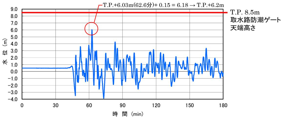
図-2-2-34 取水路防潮ゲート前面津波波形
