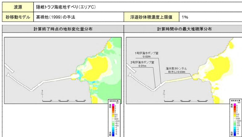
評価点付近の最大堆積厚は0.03m程度である。
