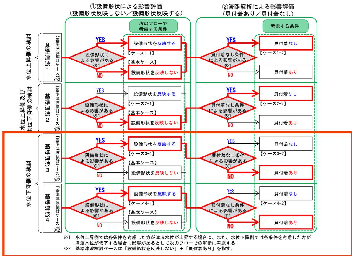
図-1-4-12 管路解析による影響評価結果
