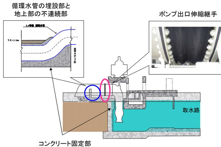
図-2-4-26 循環水ポンプ出口配管断面
