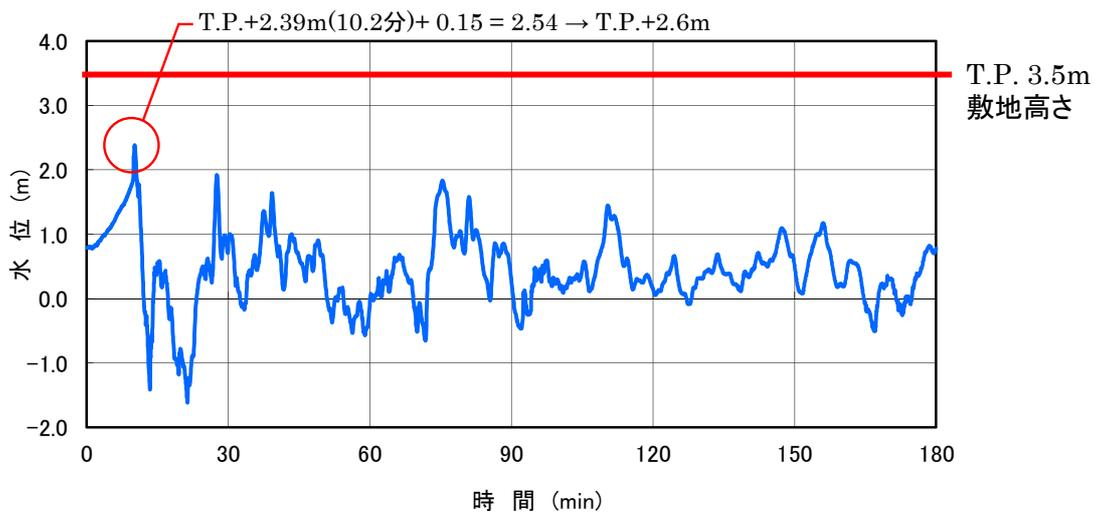
図-2-2-39 2号炉海水ポンプ室 津波波形
