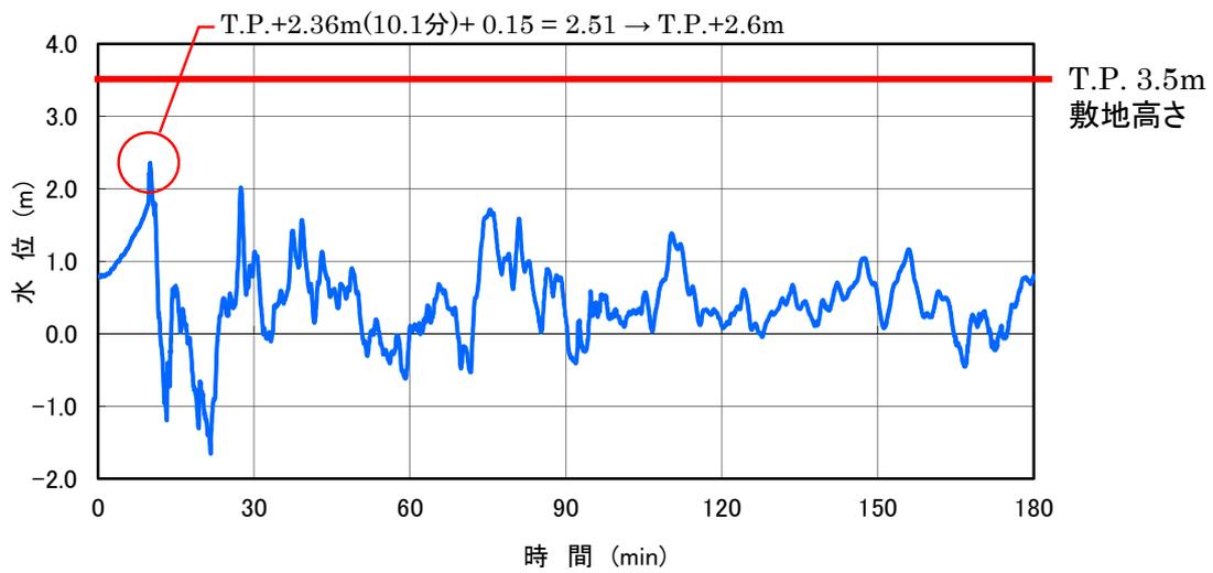
図-2-2-37 1号炉海水ポンプ室 津波波形
