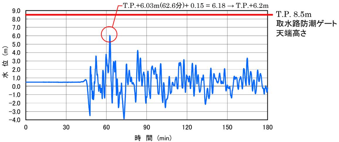
図-2-2-7 取水路防潮ゲート前面津波波形
