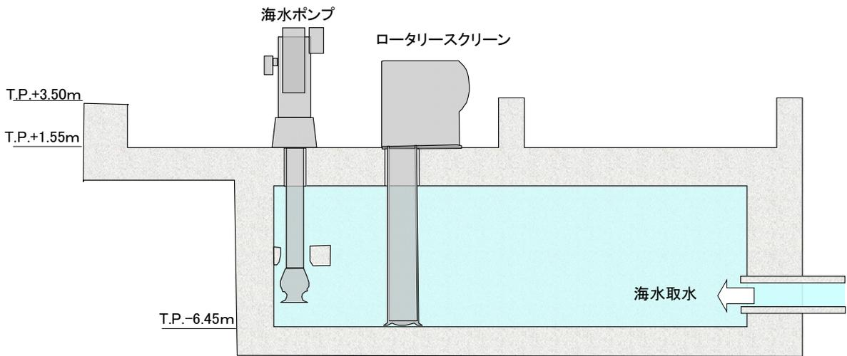
図-2-3-10 3, 4号炉海水取水設備（断面図）
