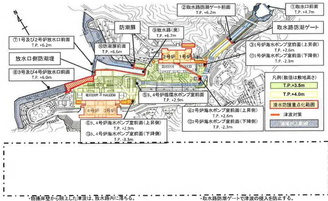
敷地への津波朔上を考慮したシミュレーションにより、浸水防護対象に基準津波が到達しないことを確認した。
