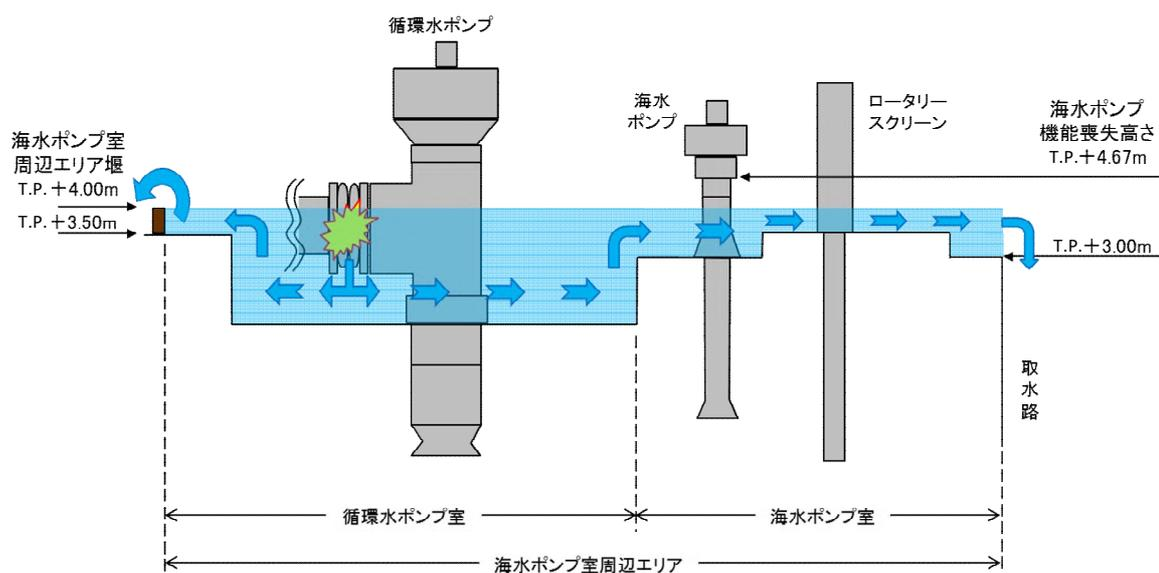
図-2-4-20 海水ポンプ室周辺エリア 断面図
