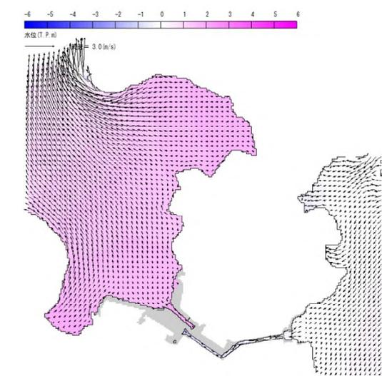
隠岐トラフ海底地すべりエリア C の計算
