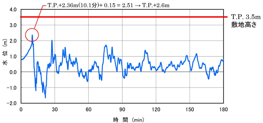
図-2-2-18 1号炉海水ポンプ室 津波波形
