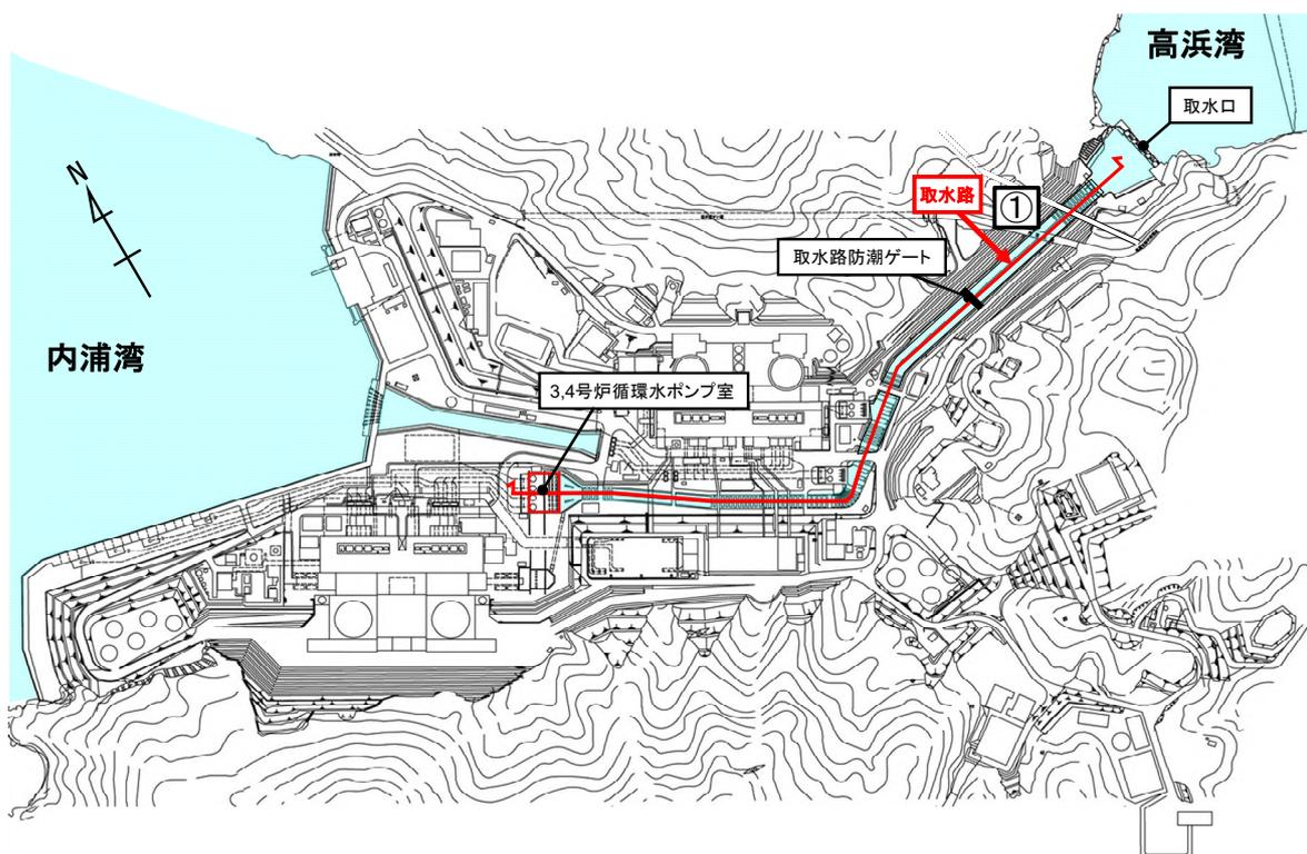
図-2-2-29 3, 4号炉海水取水系配置図
