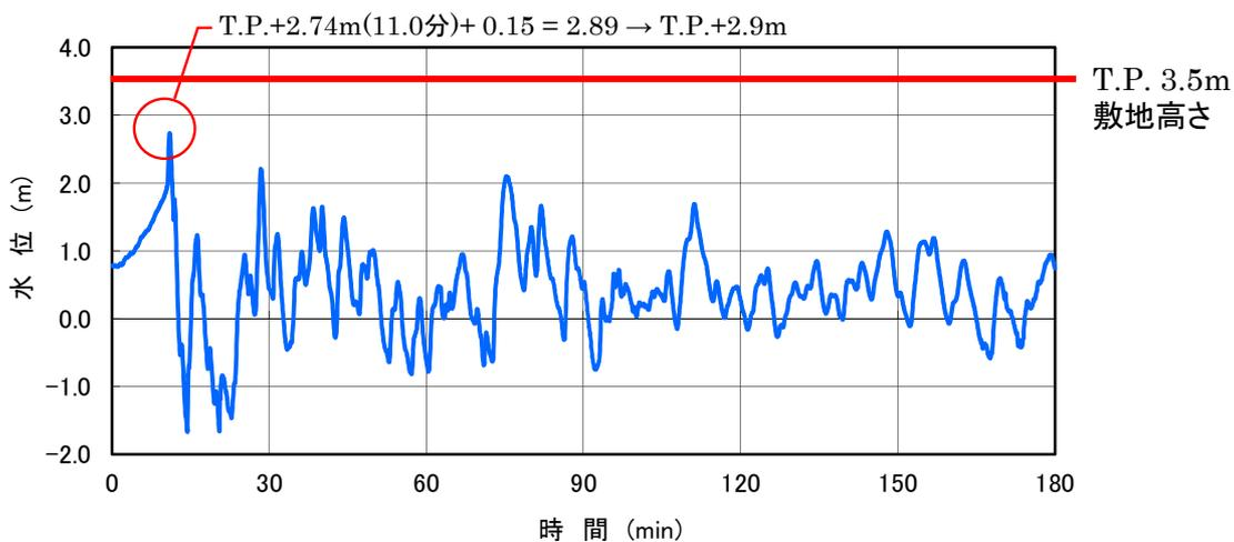
図-2-2-40 3,4号炉循環水ポンプ室 津波波形
