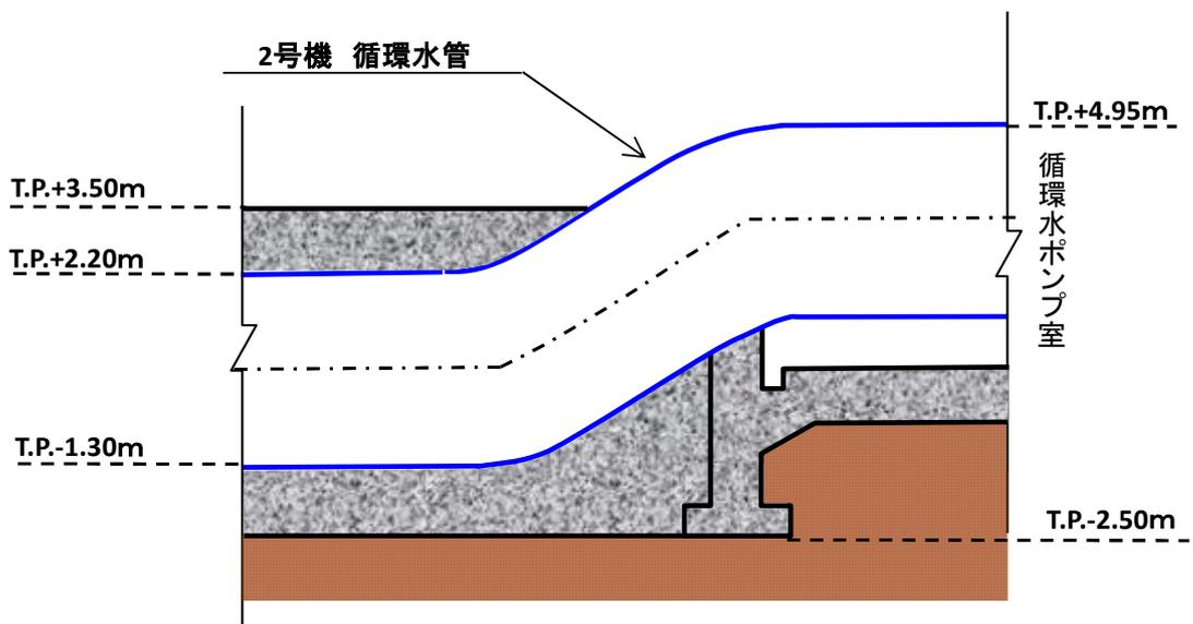
図-2-2-20 2号機循環水管埋設部 断面図④
