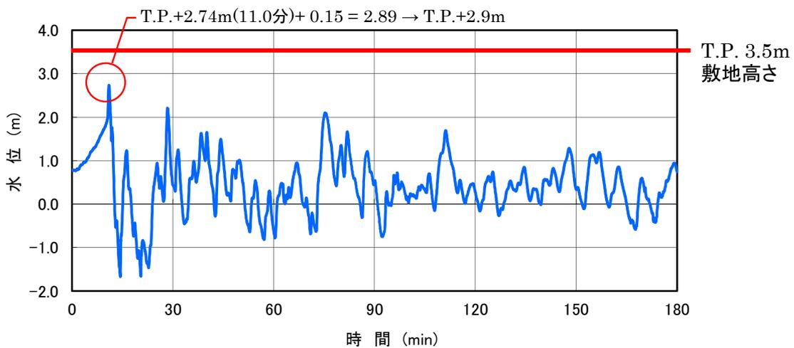
図-2-2-35 3,4号炉循環水ポンプ室 津波波形
