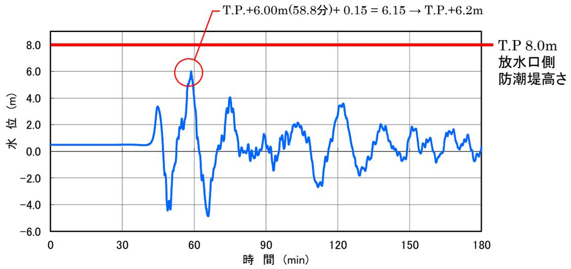
図-2-2-44 1号及び2号炉 放水口前面津波波形
