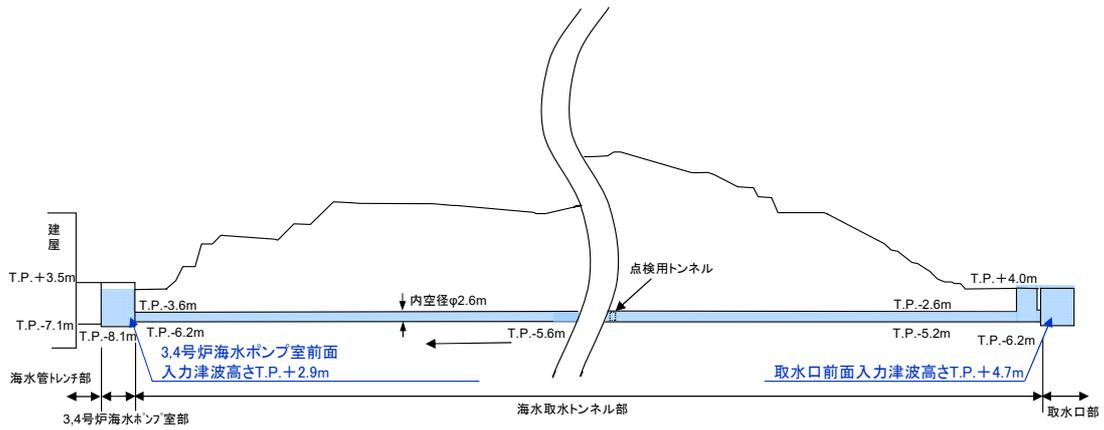
海水取水トンネル断面図
