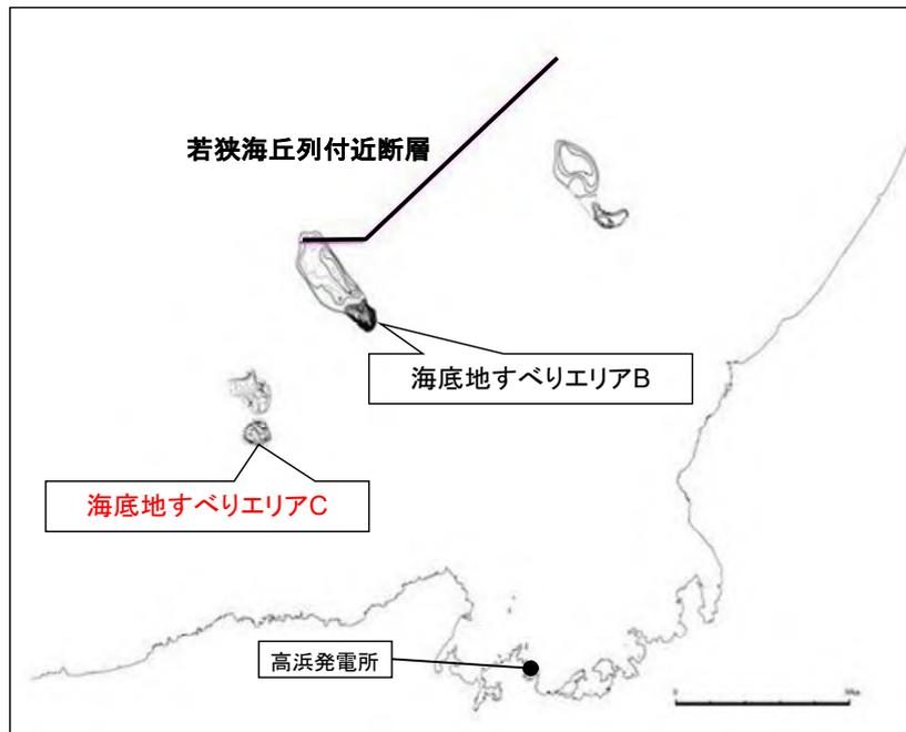
基準津波 1 (若狭海丘列付近断層と隠岐トラフ海底地すべりエリア B)
