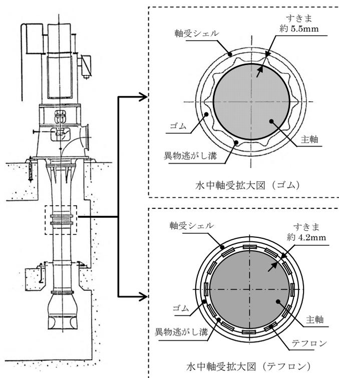
図-2-5-3 (2/2) 海水ポンプ軸受構造図
