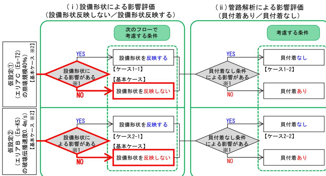
※1 各条件を考慮した方が1波目の水位低下量が小さくなる場合に影響があるととして次のフローでの解析に考慮する。
