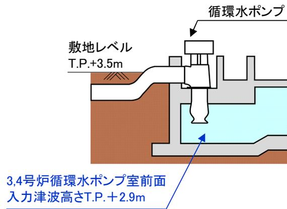
図-2-2-32 3,4号炉循環水ポンプ室断面図
