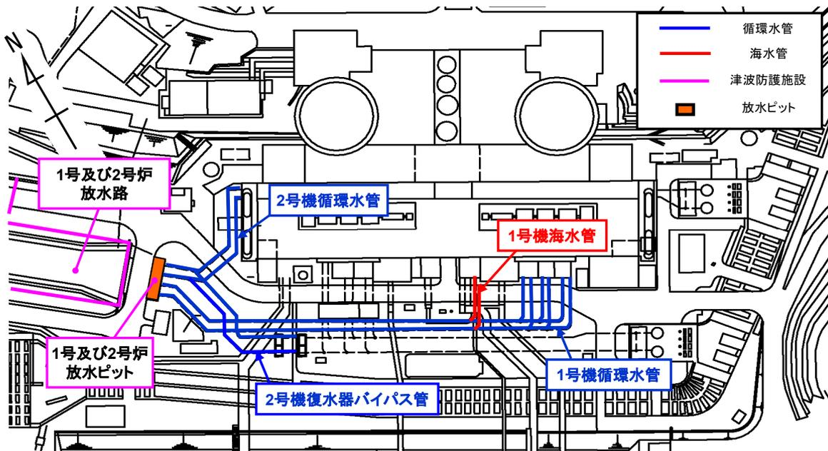
図-2-2-45 1,2号炉 放水路系配置図
