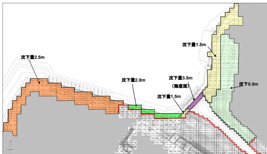
図-1-3-1 現地盤からの沈下量想定
