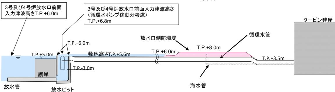
図-2-2-51 3号及び4号炉 放水路系配置図
