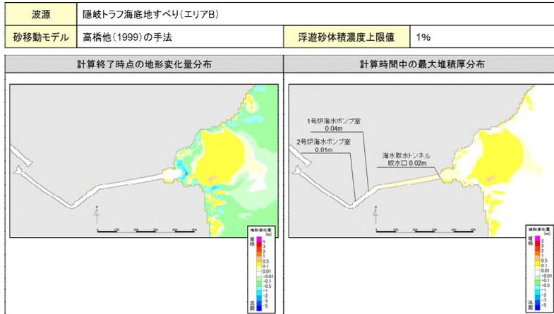
評価点付近の最大堆積厚は0.04m程度である。
