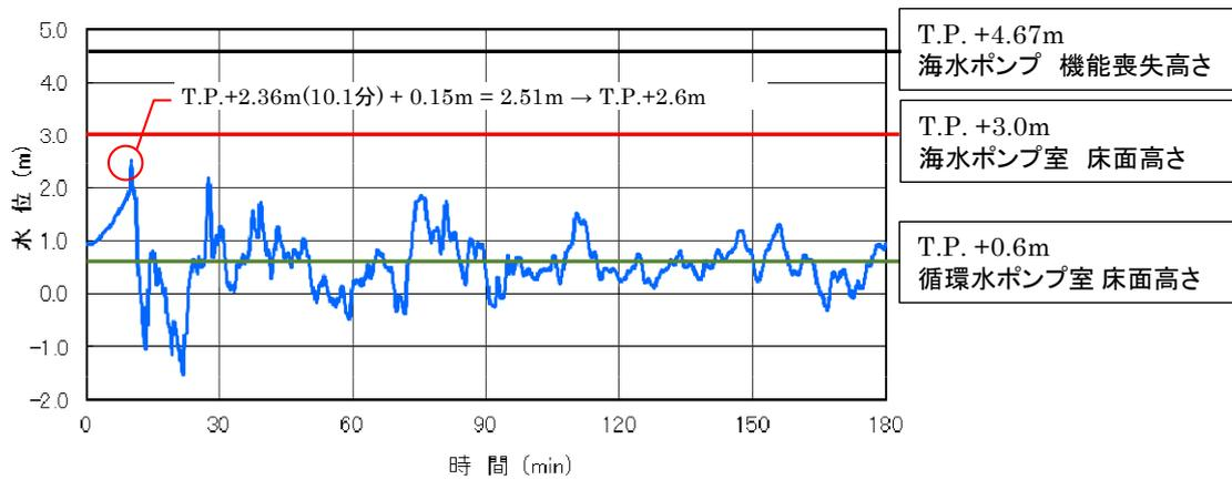
図-2-3-3 1号炉海水ポンプ室前津波波形
