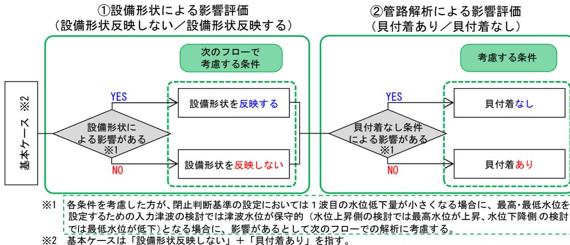
図-1-4-2 取水口側の影響評価検討フロー
