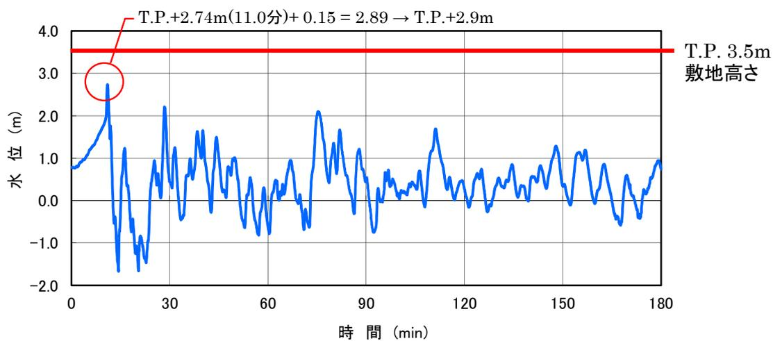
図-2-2-26 3,4号炉循環水ポンプ室 津波波形
