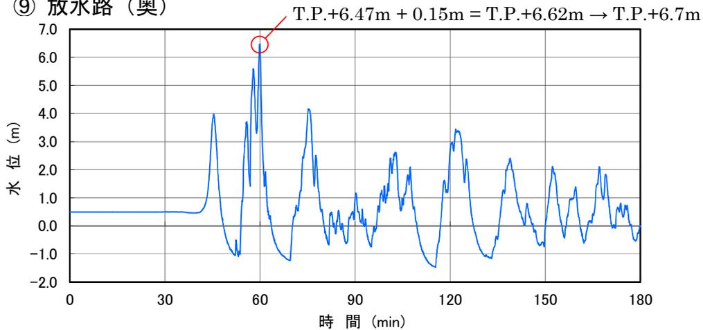
図-1-6-2 入力津波の時刻歴波形 (3/5)
