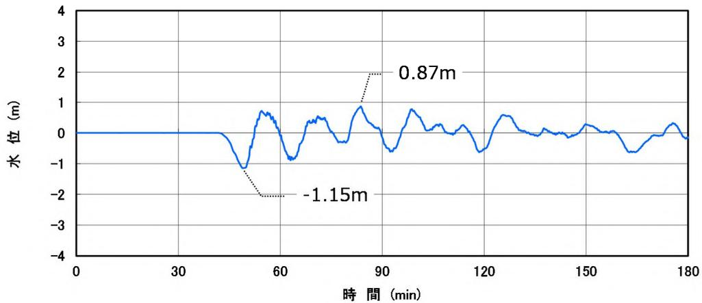
※基準津波 3 及び基準津波 4 は、崩壊規模及び破壊伝播速度の値に幅を持たせた波源を選定し策定することから、その値によって津波の計算結果は異なるが、一例として、最大値での基準津波定義位置の時刻歴波形を示す。
