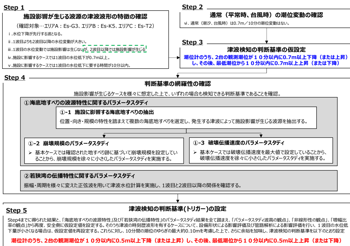
図1 津波検知の判断基準（トリガー）の網羅性・妥当性に関する検討フロー
