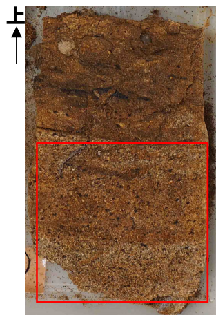
5cm 薄片試料写真(作成前)
