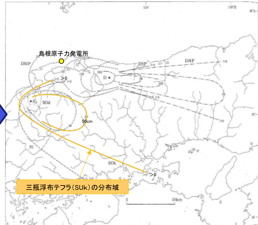
図 3.2-1 中国地方の後期更新世主要テフラの等層厚線図。 SUK 三瓶浮布 (1,2) SI 三瓶池田 (3,4) SOd 三瓶大田 (5,6) (点線内が pH 分布域) DSP 大山開金 (7,8) DNP 大山生竹 (9,10) DMP 大山松江 (11,12) D:大山, S:三瓶 (1) 林・三浦(1987), (2) 町田・新井(1979), (3) 津久井(1984), (4) 竹村ほか(1994), (5) 吉川ほか(1986), (6) Ooi(1992), (7) 加藤ほか(1996)
