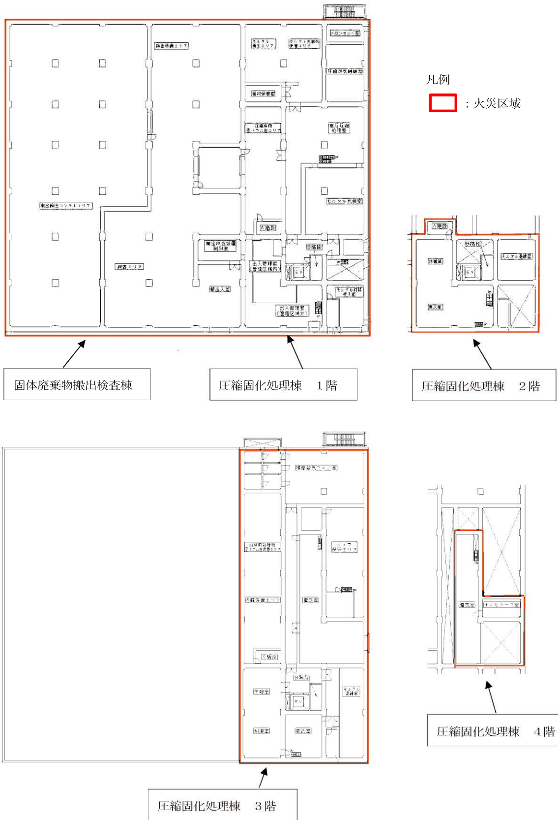
第8-1図 廃棄物搬出設備の火災区域(1/2)
